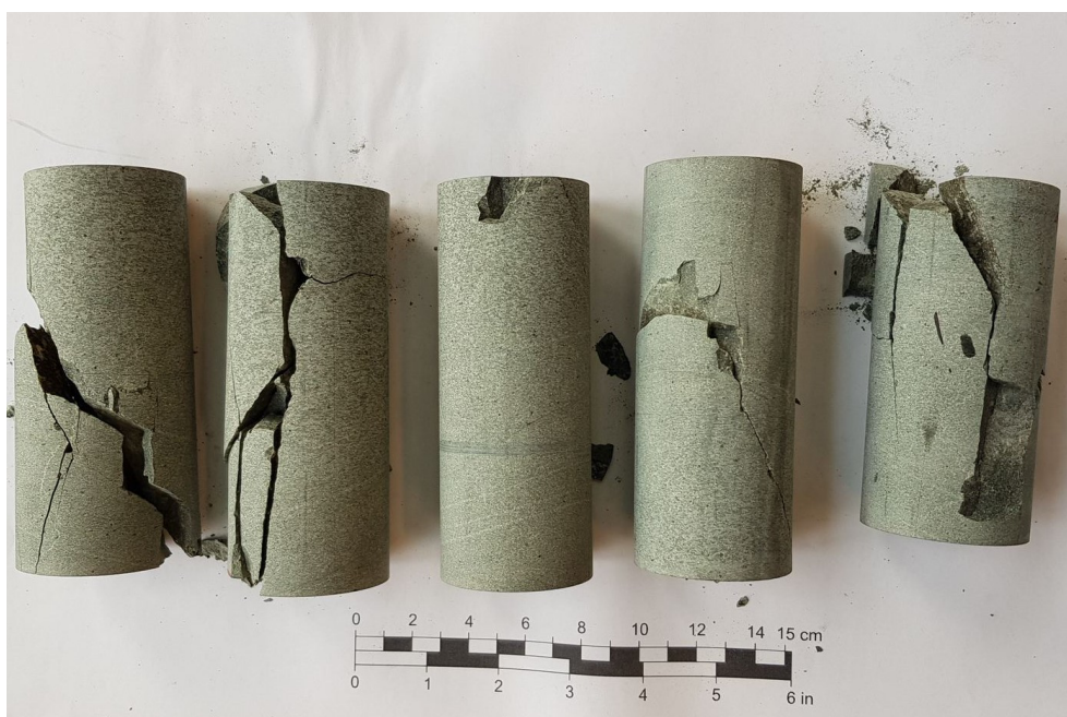
Figur 25: Kjerneprøvene etter utført enaksialt trykkforsøk. (Foto: A. Søyseth)
