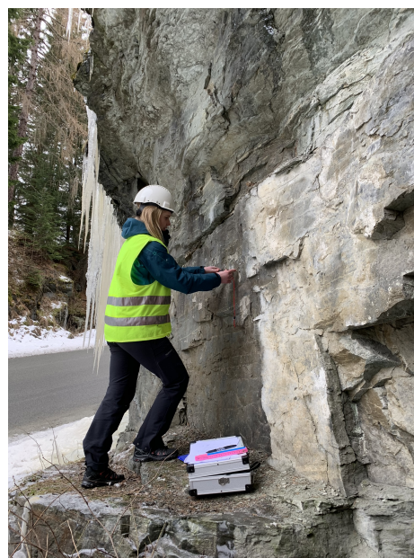
Figur 18: Gjennomfører strøk- og fallmålinger. (Foto: M. H. Hansen)
