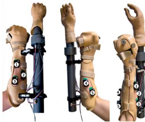
Figur 5: Protesen brukes av proteselaboratoriet til NTNU. Figuren fra er Fougner et al. (utgis senere) og er lisensiert under Creative Commons BY-NC-SA license (heretter forkortet til opphavsrett: CC BY-NC-SA)
