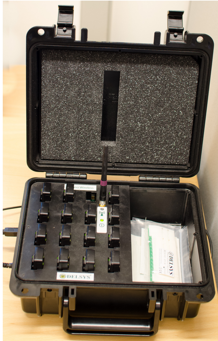
Figur 8: Bildet over viser Delsys Trigno Wireless System. Model Informasjon: FCC ID:W4P-SP-W01 (Sensorer), FCC ID: W4P-Sp-W02(Base Station) og IC: 818A-DTST01 (System).
