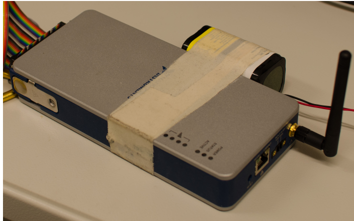
Figur 7: Her er DAQ-enheten brukt ved det nevrologiske laboratoriet. Modell nummer: cDAQ-9191
