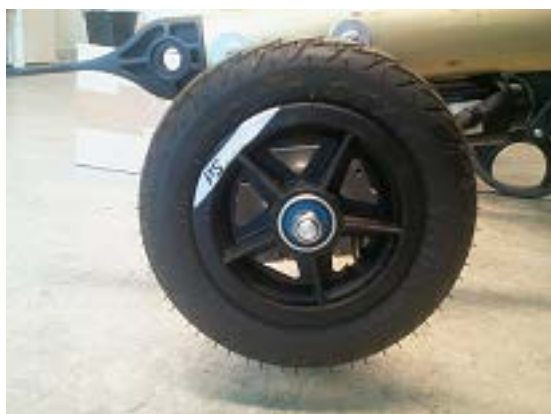
Figur 31 Ferdig monterte hjul med frinav
