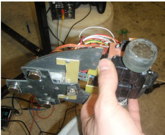
Figur 225: Rensar med fire kontaktpunkter påmontert robot med to hjul
