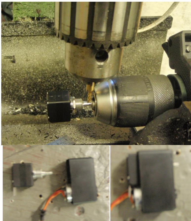
Figur 55: Tilpassing av optisk enkoder i servo
