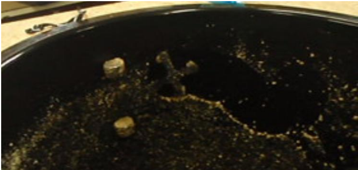
Figur 194: Rensing av tankvegg med sagflis og vann
