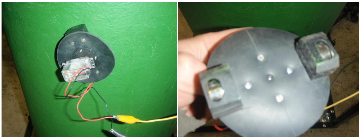
Figur 223: Forsøk med roterende renser, to kontaktpunkter
