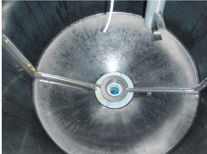
Figur 12: Innvendig viskere i tank
