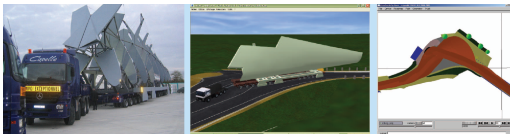
Figur 1.1.: Ruteplanlegging for en flydelfraktende lastebil med 20 par styrehjul. Bilderrettigheter tilhører Kineo CAM.
