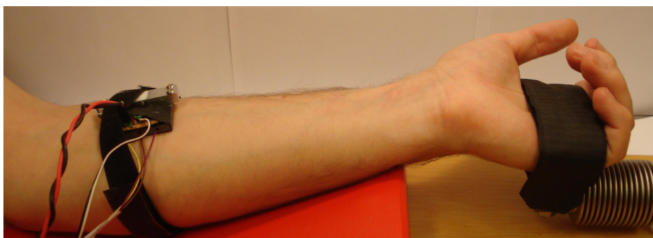
Figur 5.2: Forsøkspersonen med elektrode montert over flexor carpi radialis og hånden festet på kraftcellen
