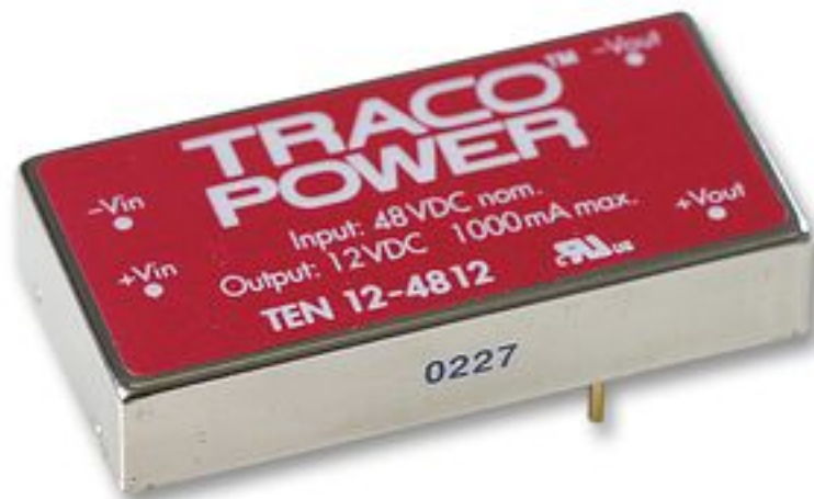
Figur 42: Traco DC-DC omformer med 18-75V inngang og 12V utgang. Omformeren tar strøm fra brenselcellen og er spenningsforsyning for kjøleviften til brenselcellestacken.
