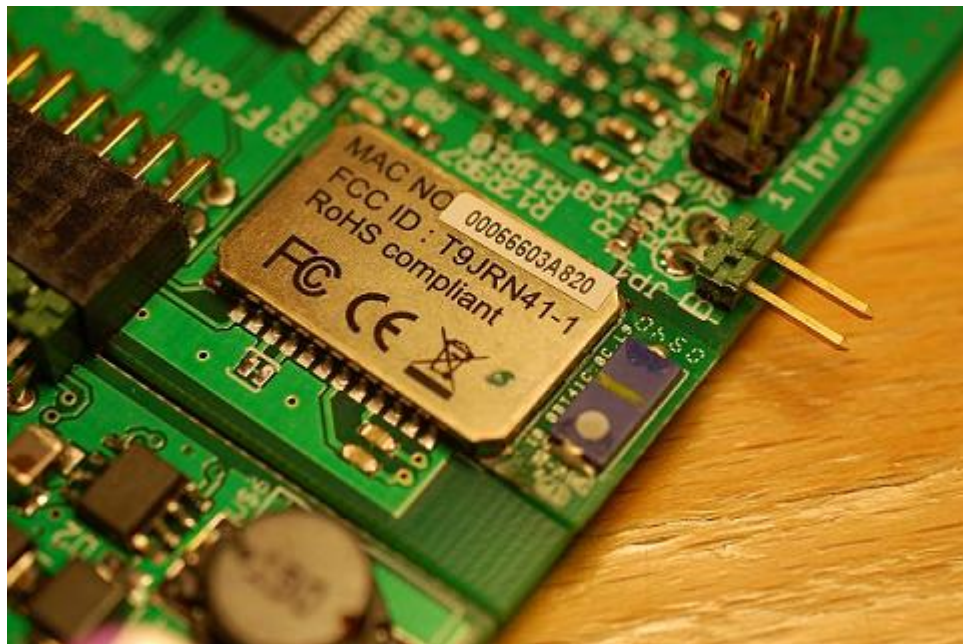
Figur 29: Blåtannmodul fra Sparkfun montert på frontmodulkretskortet, jordplanet under antennen er fjernet for å få bedre rekkevidde.
