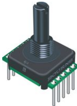
Figur 26: Absolutt-enkoder benyttet til gasspedal. Enkoderen har 128 steg per omdreining og baserer seg på elektrisk kontakt mellom stifter og sleperinger. (Bourns)
