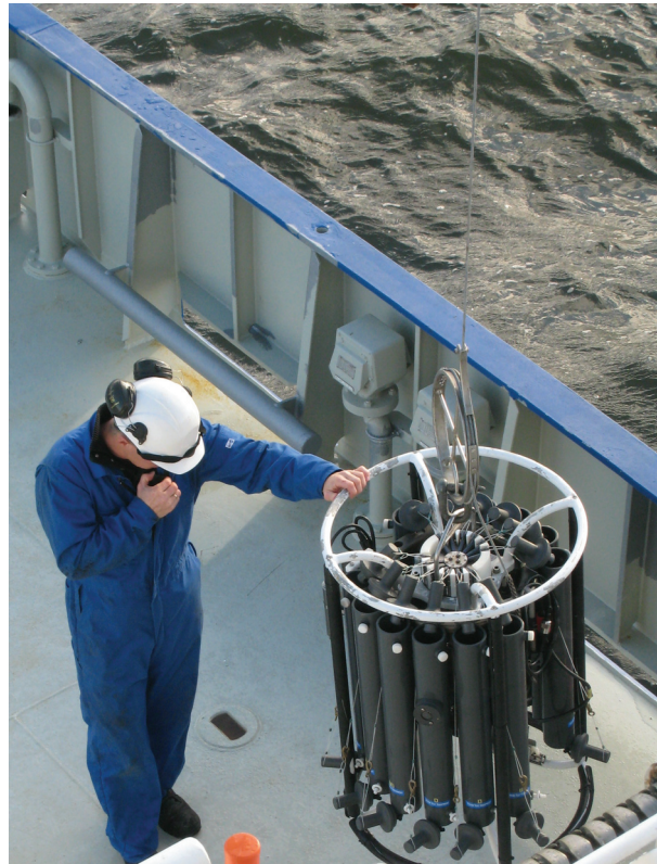
Figur 2.5: Instrument for måling av forskjellige sjøvannsparmetre, ombord på RV-Gunnerus.
