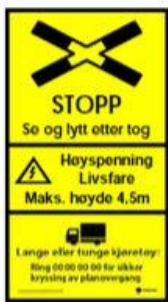
Figur 20: Eksempel på skilting ved planovergang med sikringsnivå 3a
