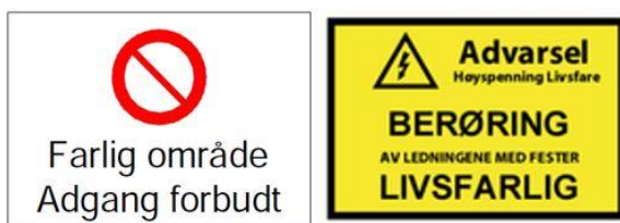
Figur 13: Advarselsskilt for tredjeperson på stasjoner
