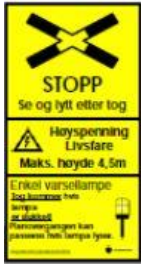
Figur 21: Eksempel på skilting ved planovergang med sikringsnivå 3b
