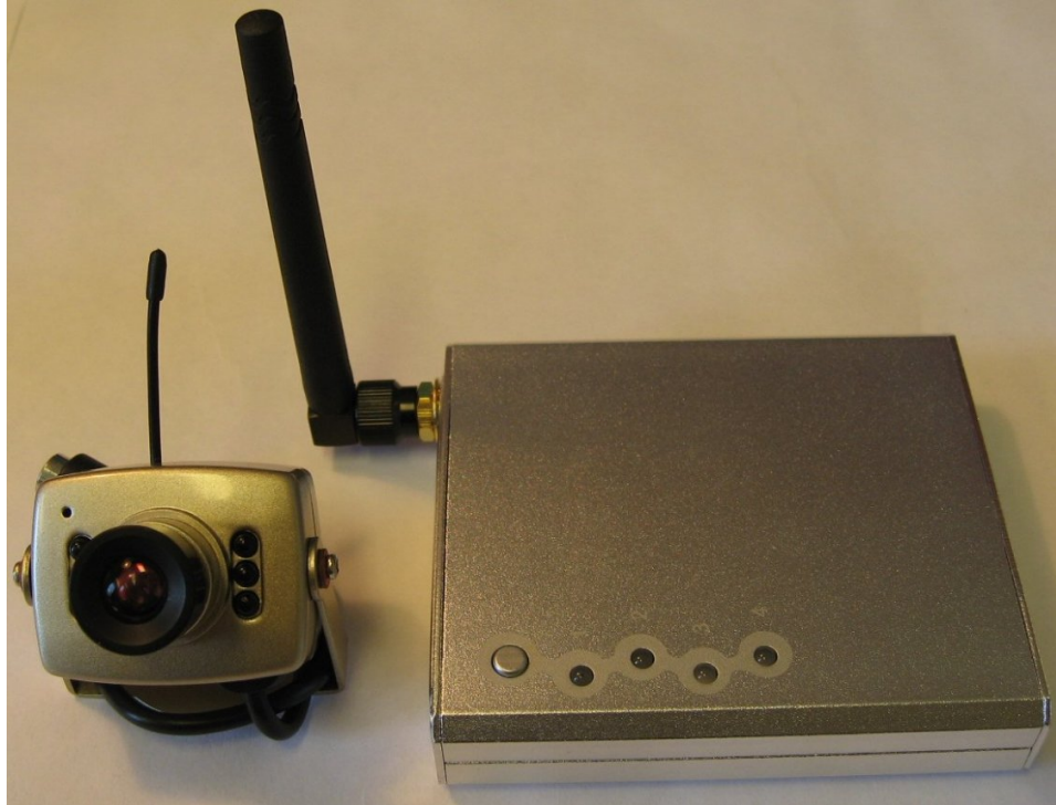
Figure 3.6: Luda Elektronik's wireless Minikameran camera with AV receiver.
