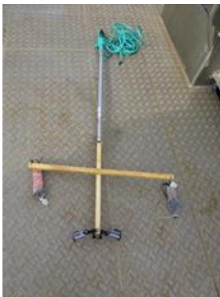
Figur 50 Oppsett med pellets og reker i to ulike poser, med GoPro kameraer til opptak.
