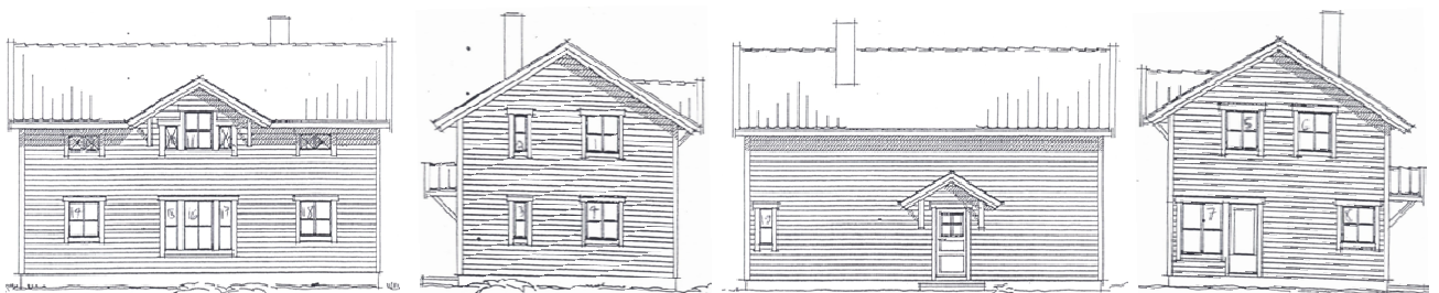
Figur 3: Fasadene til henholdsvis nord-, øst-, sør- og vestsiden av boligen hentet fra arbeidstegning 1 og 2.
