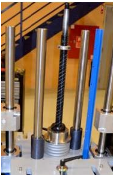
Figur 17 Skruen som brukes til å senke og løfte det nye FFWD. Per Rasmussen, Service and Support Manager Dynatest, (e-post, 14.09.2018.).
