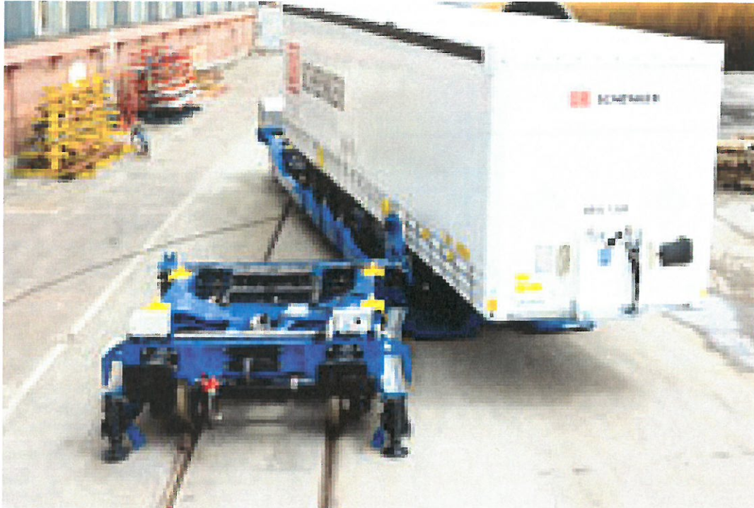
Figur 6 Påkjøringssystem for semihengere (MegaSwing)
