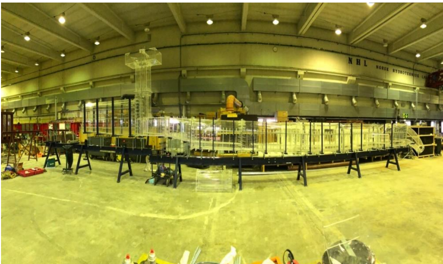
Fig.8. Modell av Tonstad-sandfanget ved Vassdragslaboratoriet, NTNU (foto: Thai Mai).
