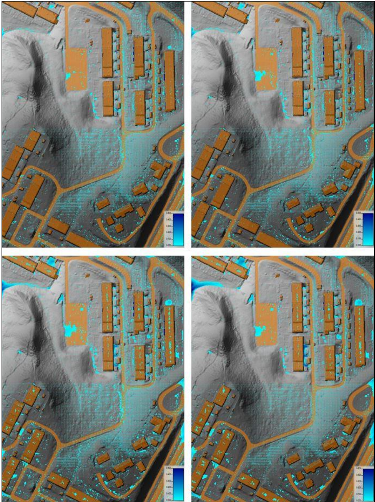
Figur 39: Resultat simulering (dynamisk bølge) av nedbør for RIS 13.09.11 – 14.09.11. Dybder for fire ulike tidspunkter. Fra øvre-venstre, øvre-høyre, nedre-venstre til nedre-høyre: 22:40, 23:00, 00:55 og 05:00. Fargeskala illustrerer dybder på 0 – 0,5 m. Arealdekkelag med tak og asfalterte flater markert med oransje.
