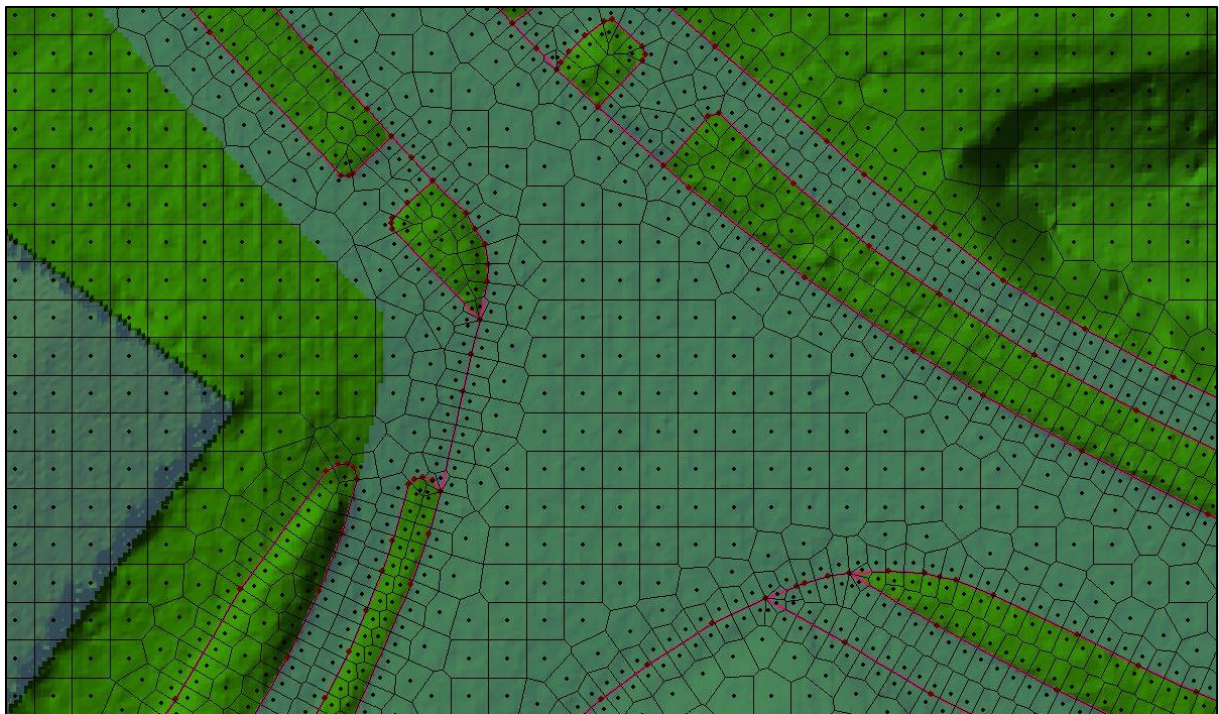
Figur 46: Utsnitt fra 2D-området til Hornebergbekken i HEC-RAS. Viser beregningsnett (grid) med bruddlinjer (rosa linje) langs vegkanter. Grid oppløsning 2 m med 1 m oppløsning langs veikanter. Arealdekkelag for tak og asfalterte flater markert med blå-grå. Illustrerer et kryss lokalisert vest i nedbørsfeltet (der Leirfossvegen møter Fossegrenda).
