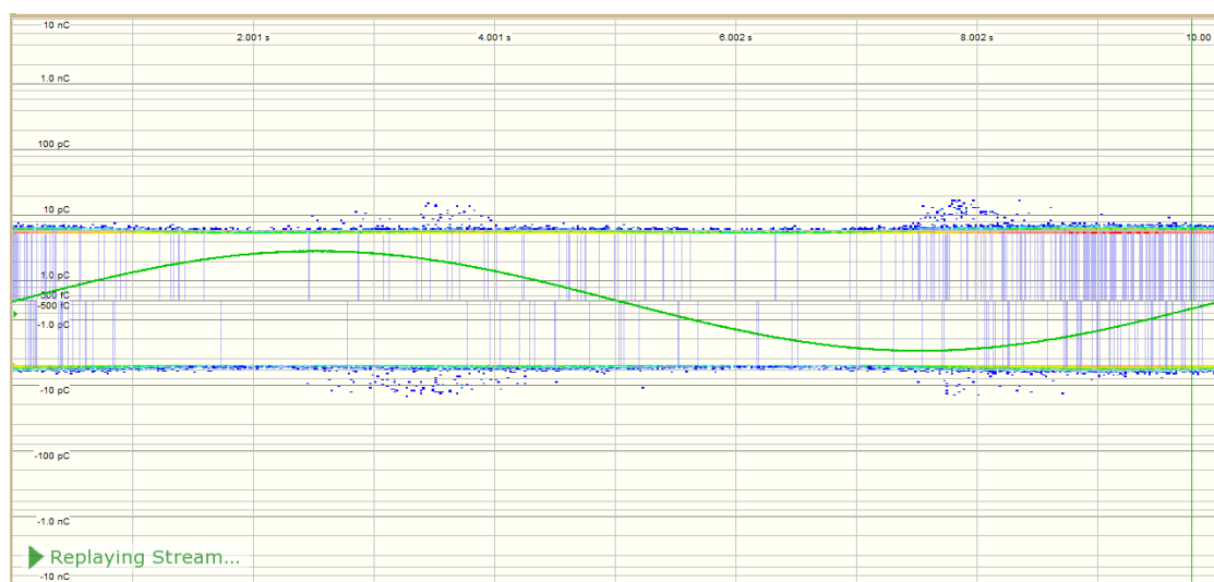
Figur C.33: Utladninger i Kabelskjøt C, når tennspenning (5,0 kV) er oppnådd ved 0,1 Hz. Støynivået er på 5,0 pC.
