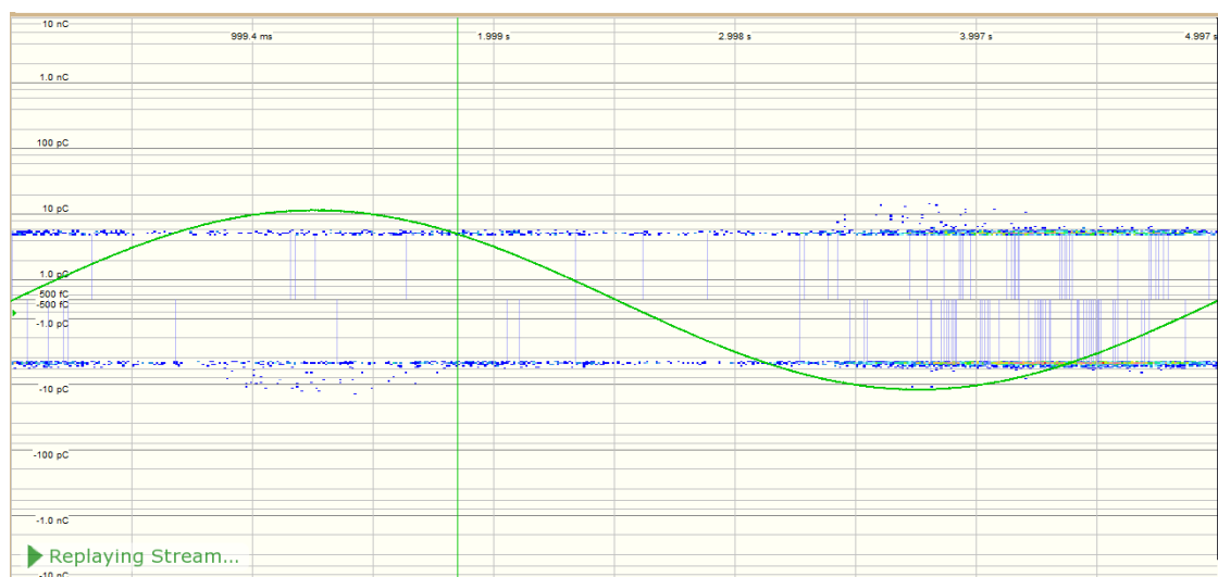
Figur C.12: Utladninger i Kabelskjøt A, når tennspenning (9,0 kV) er oppnådd ved 0,2 Hz. Støynivået er på 4,7 pC.
