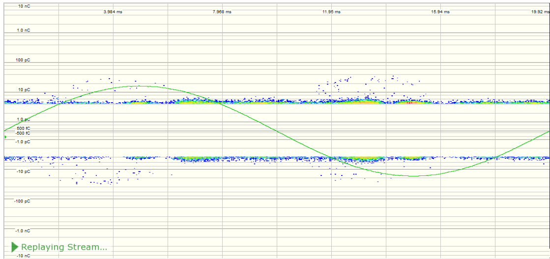
Figur C.25: Utladninger i Kabelskjøt C, når tennspenning (10,0 kV) er oppnådd ved 50,2 Hz. Støynivået er på 4,0 pC.
