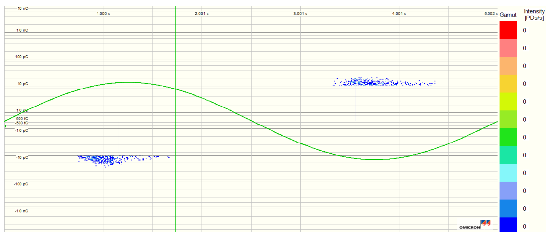
Figur C.49: Utladninger i Kabelskjøt C, under måling gjort ved 0,2 Hz og 9,5 kV. Målingen utføres i 50 minutter, og har en støygrense på 10,0 pC. 50 minutter ved 0,2 Hz tilsvarer 600 perioder, som kan sammenlignes med de andre frekvensene det måles ved.
