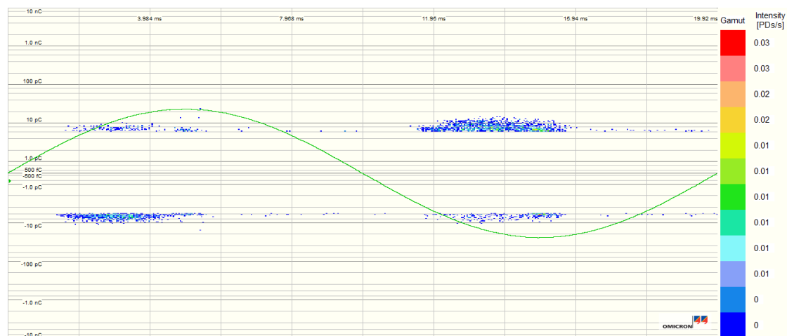
Figur C.36: Utladninger i Kabelskjøt A, under måling gjort ved 50,2 Hz og 11,0 kV. Figuren viser en målesekvens på 5 minutter, hvor støynivået er 6 pC. 600 tilfeldige perioder velges senere ut fra denne målesekvensen, for å kunne sammenligne verdiene med målinger gjort ved andre frekvenser.
