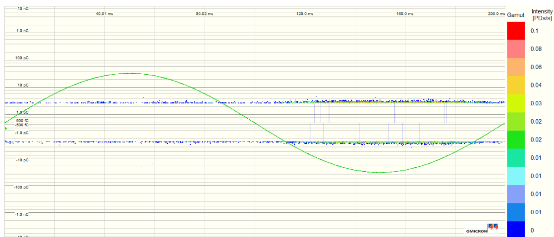
Figur D.9: PD-måling gjort på termineringer i referansekabel, ved 12 kV og 5 Hz.
