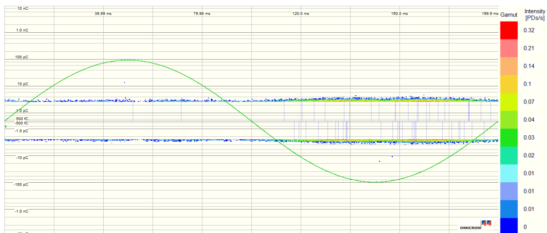
Figur D.10: PD-måling gjort på termineringer i referansekabel, ved 15 kV og 5 Hz.
