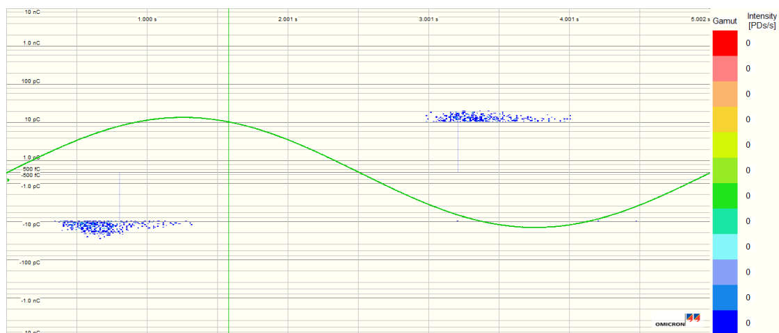
Figur C.50: Utladninger i Kabelskjøt C, under måling gjort ved 0,2 Hz og 9,5 kV, forskjøvet med 25,7 grader mot venstre.
