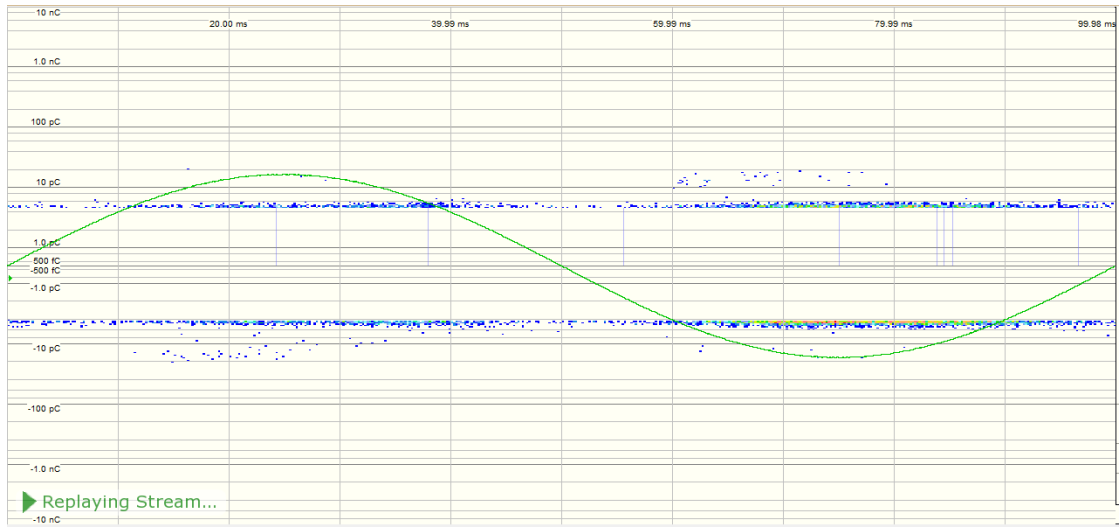
Figur C.7: Utladninger i Kabelskjøt A, når tennspenning (10,0 kV) er oppnådd ved 10 Hz. Støynivået er på 4,4 pC.
