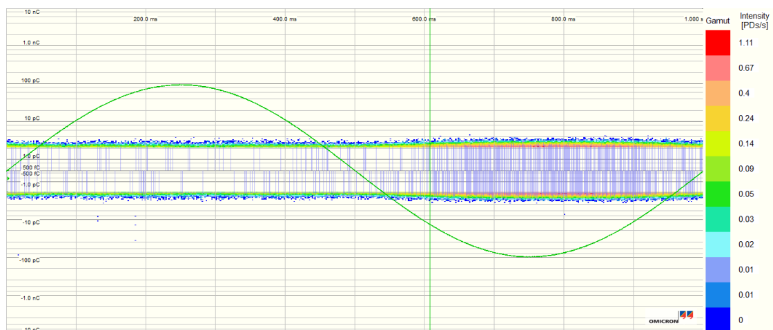
Figur D.14: PD-måling gjort på termineringer i referansekabel, ved 15 kV og 1 Hz.
