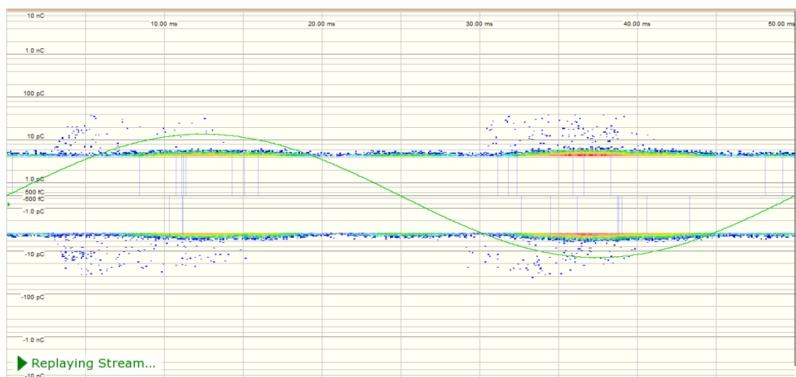
Figur C.16: Utladninger i Kabelskjøt B, når tennspenning (9,5 kV) er oppnådd ved 20 Hz. Støynivået er på 4,0 pC.
