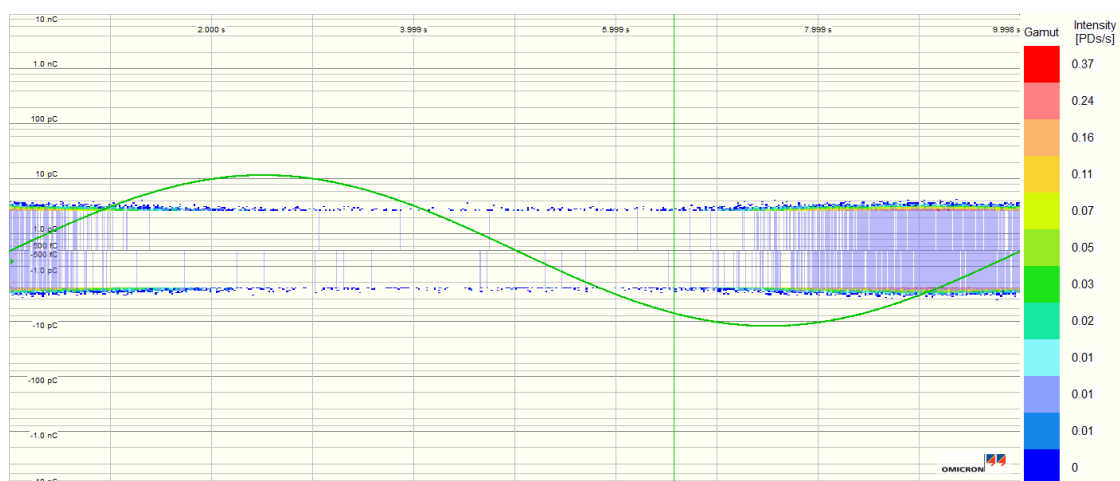
Figur D.19: PD-måling gjort på termineringer i referansekabel, ved 9 kV og 0,1 Hz.
