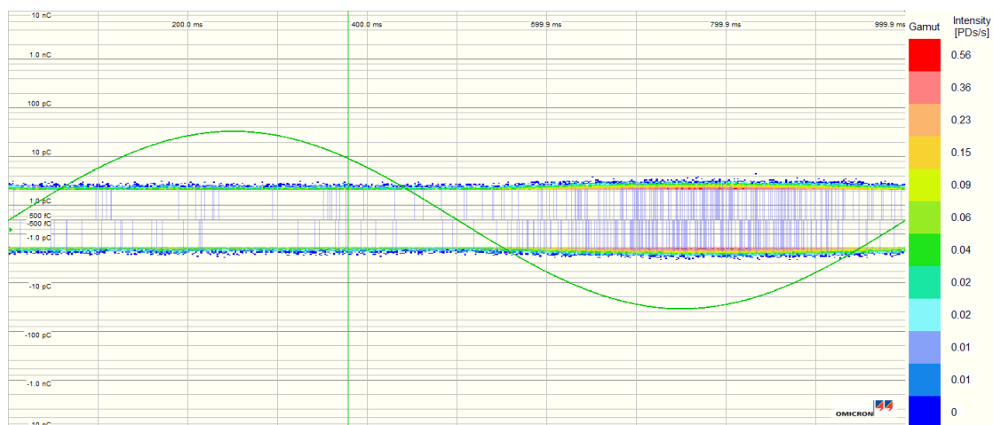
Figur D.13: PD-måling gjort på termineringer i referansekabel, ved 12 kV og 1 Hz.
