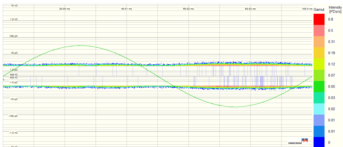
Figur D.7: PD-måling gjort på termineringer i referansekabel, ved 12 kV og 10 Hz.
