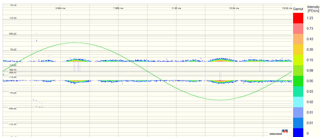
Figur D.3: PD-måling gjort på termineringer i referansekabel, ved 12 kV og 50,2 Hz.
