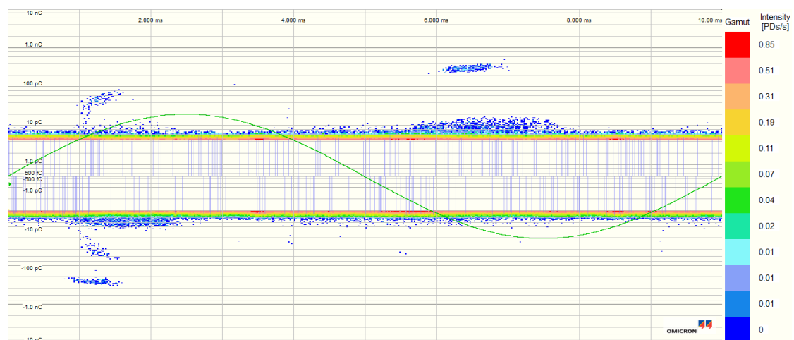
Figur C.34: Utladninger i Kabelskjøt A, under måling gjort ved 100 Hz og 10,5 kV. Målingen utføres i fem minutter, og har en støygrense på 4 pC. 600 tilfeldige perioder velges senere ut, ved hjelp av Matlab, for å kunne sammenligne med målinger gjort ved andre frekvenser. Støygrensen er her for lav, og justeres derfor som vist i FigurC.35.
