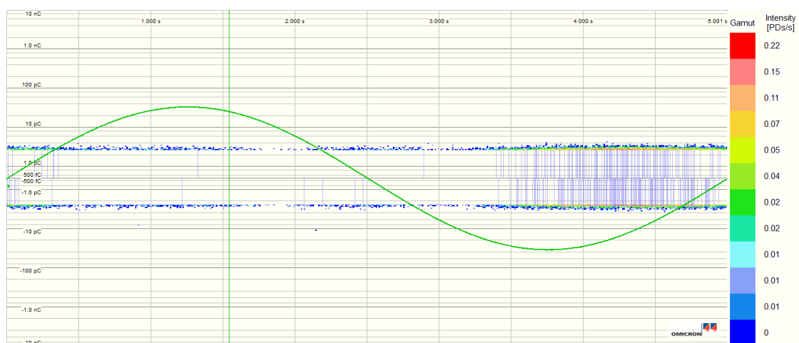
Figur D.17: PD-måling gjort på termineringer i referansekabel, ved 12 kV og 0,2 Hz.
