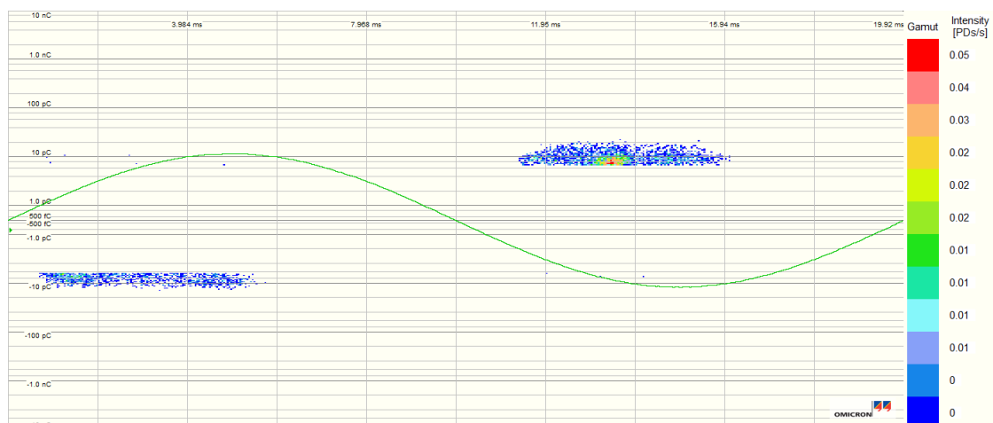
Figur C.42: Utladninger i Kabelskjøt B, under måling gjort ved 50,2 Hz og 9,0 kV. Målingen utføres i fem minutter, og har en støygrense på 6,5 pC. 600 tilfeldige perioder velges senere ut, ved hjelp av Matlab, for å kunne sammenligne med målinger gjort ved andre frekvenser.
