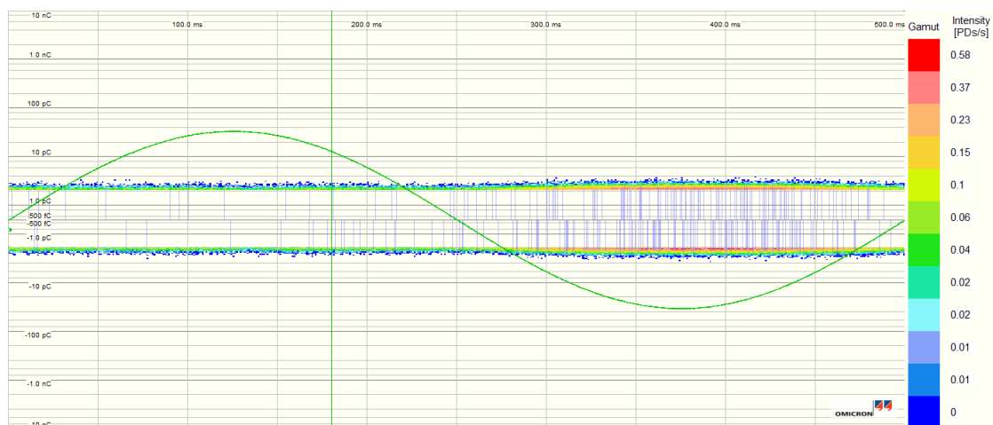
Figur D.11: PD-måling gjort på termineringer i referansekabel, ved 12 kV og 2 Hz.
