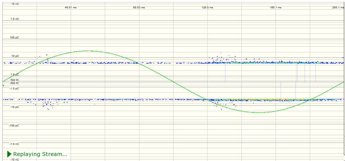
Figur C.8: Utladninger i Kabelskjøt A, når tennspenning (11,0 kV) er oppnådd ved 5 Hz. Støynivået er på 4,6 pC.
