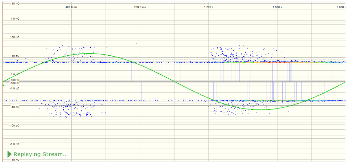
Figur C.21: Utladninger i Kabelskjøt B, når tennspenning (10,0 kV) er oppnådd ved 0,5 Hz. Støynivået er på 5,0 pC.
