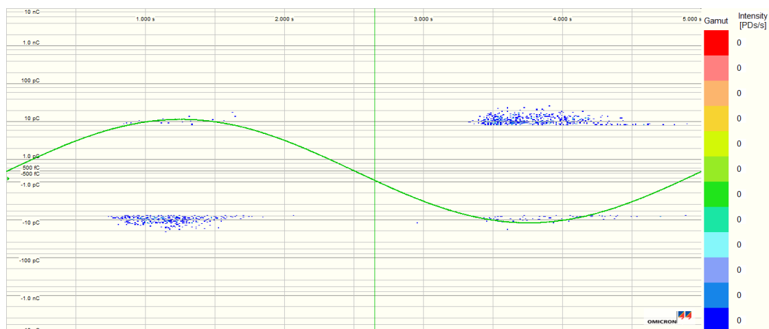
Figur C.37: Utladninger i Kabelskjøt A, under måling gjort ved 0,2 Hz og 9,0 kV. Figuren viser en målesekvens på 50 minutter, hvor støynivået er 8 pC. 50 minutter ved 0,2 Hz tilsvarer 600 perioder, som kan sammenlignes med de andre frekvensene det måles ved.
