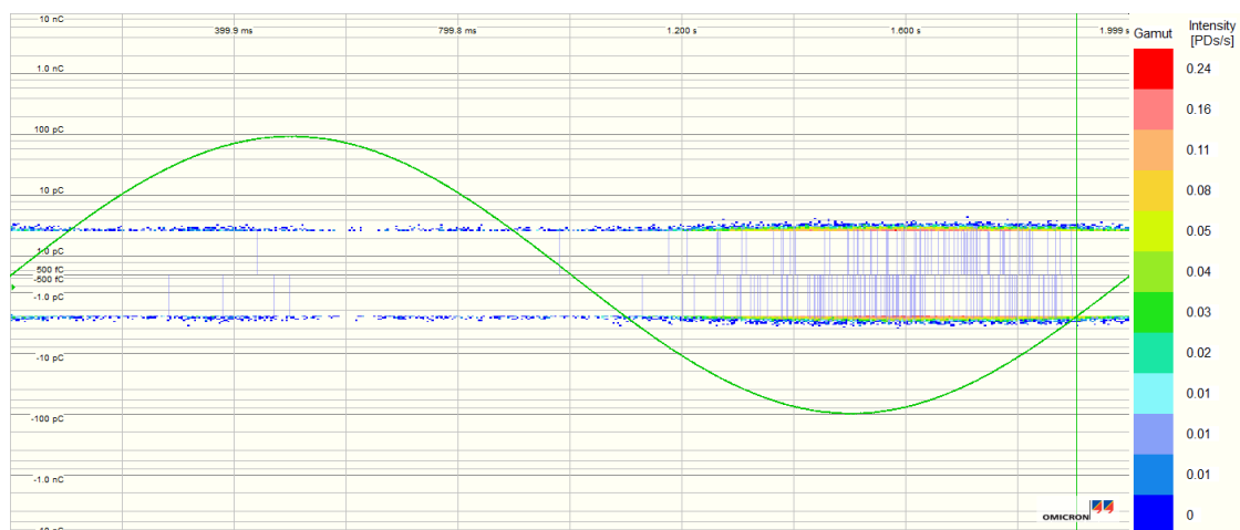
Figur D.16: PD-måling gjort på termineringer i referansekabel, ved 15 kV og 0,5 Hz.
