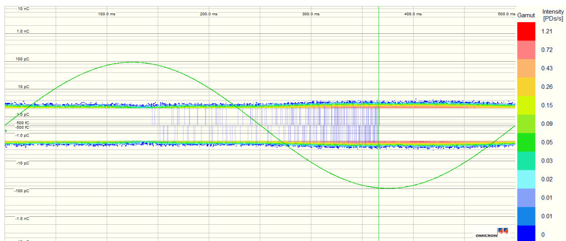
Figur D.12: PD-måling gjort på termineringer i referansekabel, ved 15 kV og 2 Hz.
