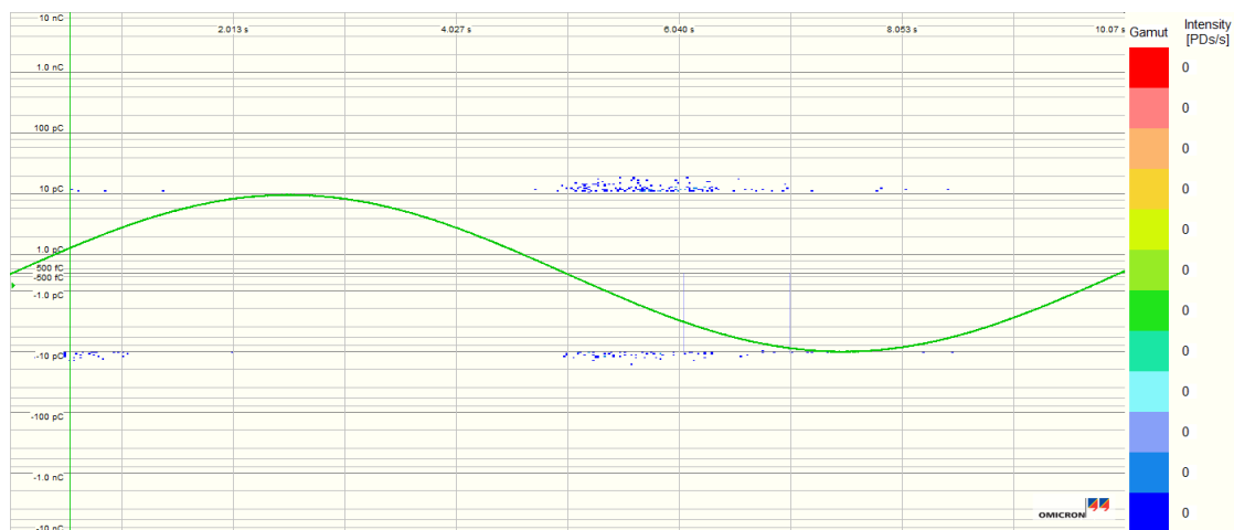
Figur C.40: Utladninger i Kabelskjøt A, under måling gjort ved 0,1 Hz og 8,5 kV. Figuren viser det samme som Figur C.39, bare med en faseforskyvning på 69,8 grader mot venstre. Dette er på grunn av de kapasitive egenskapene til målekretsen, som gir en forskyvning av utladningene ved lave frekvenser.
