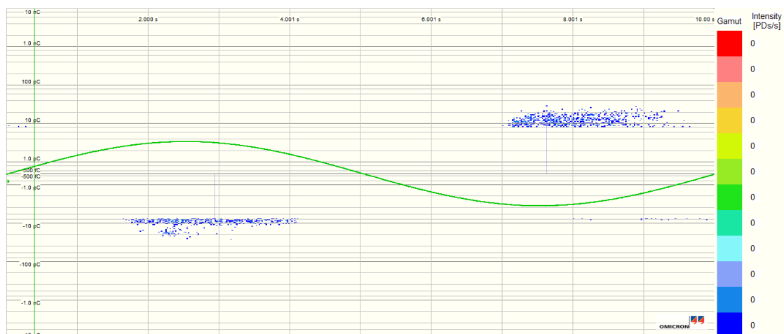
Figur C.45: Utladninger i Kabelskjøt B, under måling gjort ved 0,1 Hz og 5,5 kV. Målingen utføres i 100 minutter, og har en støygrense på 8,0 pC. 100 minutter ved 0,1 Hz tilsvarer 600 perioder, som kan sammenlignes med de andre frekvensene det måles ved.
