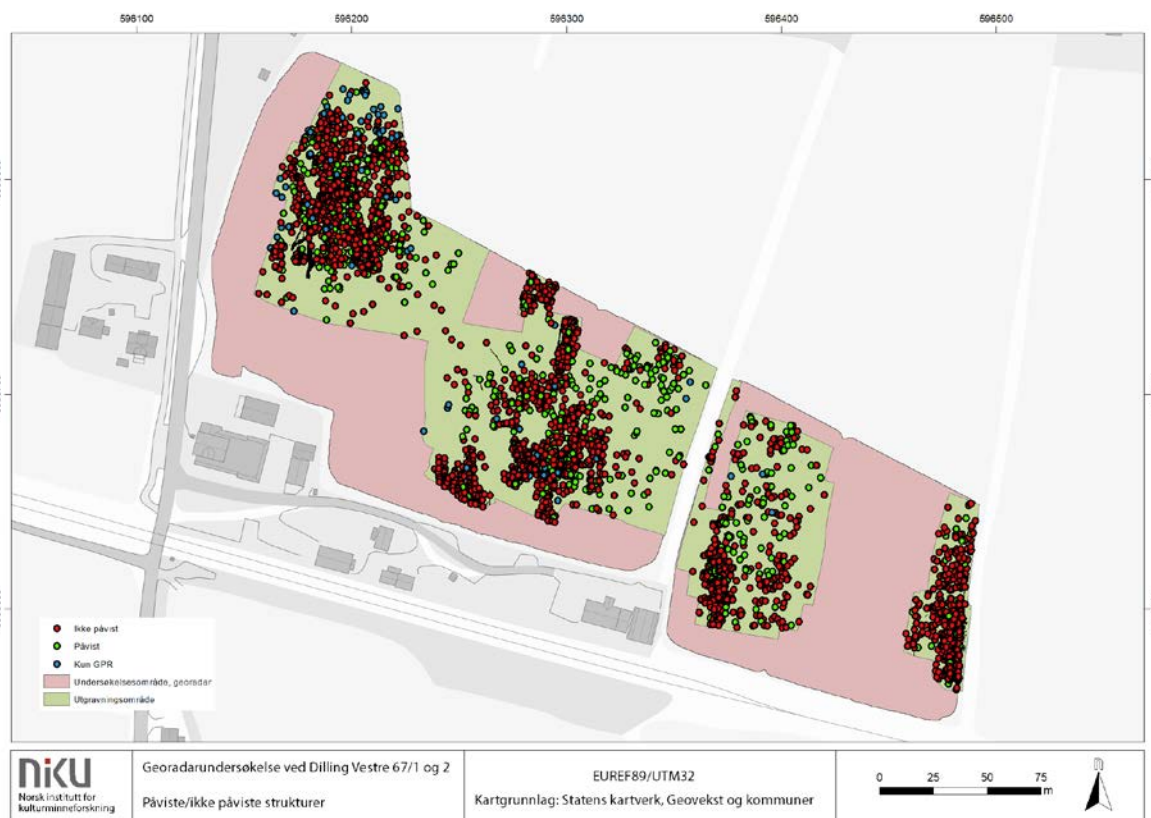
Figur 13: Eksempel på analysegrunnlag. Punktene representerer strukturer som er påvist ved hjelp av maskinell flateavdekking. De ulike fargene representerer hvorvidt strukturene er påvist i georadar-datasettene eller ikke.
