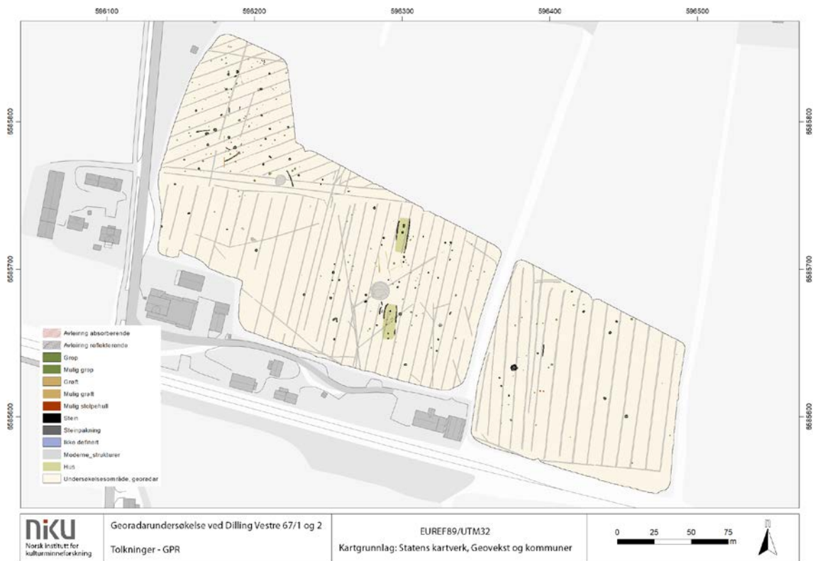
Figur 7: Tolkningskart fra georadarundersøkelsen ved Dilling.
