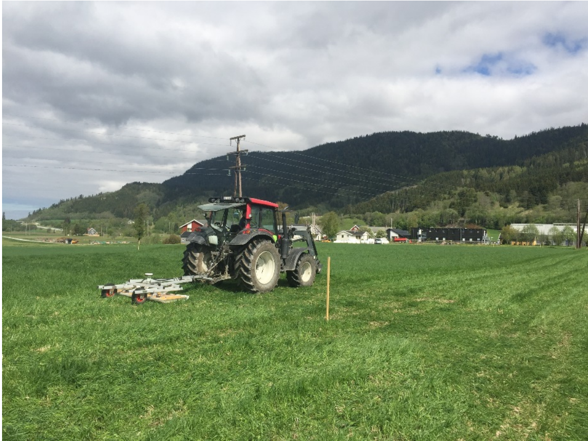
Figur 10: NTNUs 3d-radar GPR system montert på henger bak en traktor under kjøring på Øya. Foto: Arne Anderson Stamnes, NTNU Vitenskapsmuseet.
