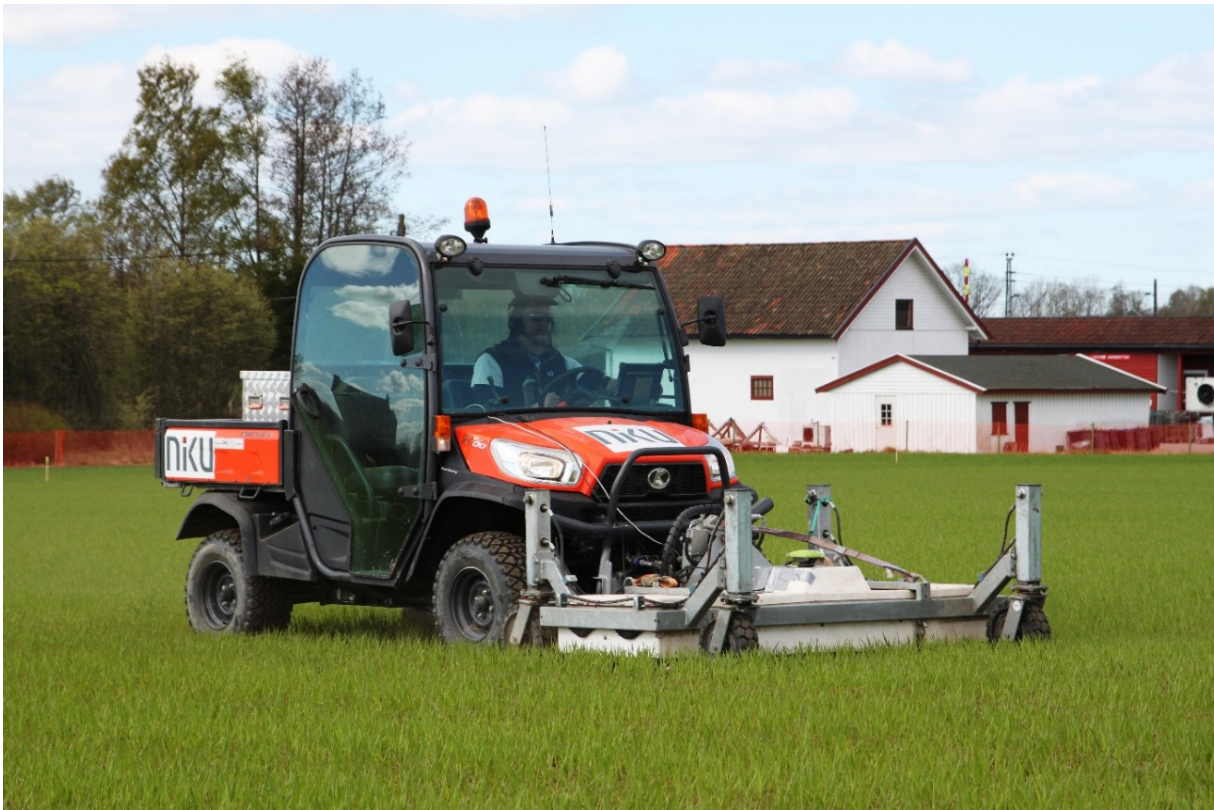
Figur 5: NIKUs MALÅ MIRA III georadarsystem under kjøring på Dilling. Radarsystemet er utviklet av forskningsinstituttet LBI ArchPro i Wien, Østerrike. Foto: Lars Gustavsen, NIKU.
