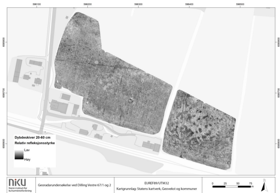
Figur 6: Eksempel på dybeskiver generert fra georadarundersøkelsen ved Dilling. Dybeskivene representerer et 40 cm tykt, horisontalt snitt gjennom undergrunnen.
