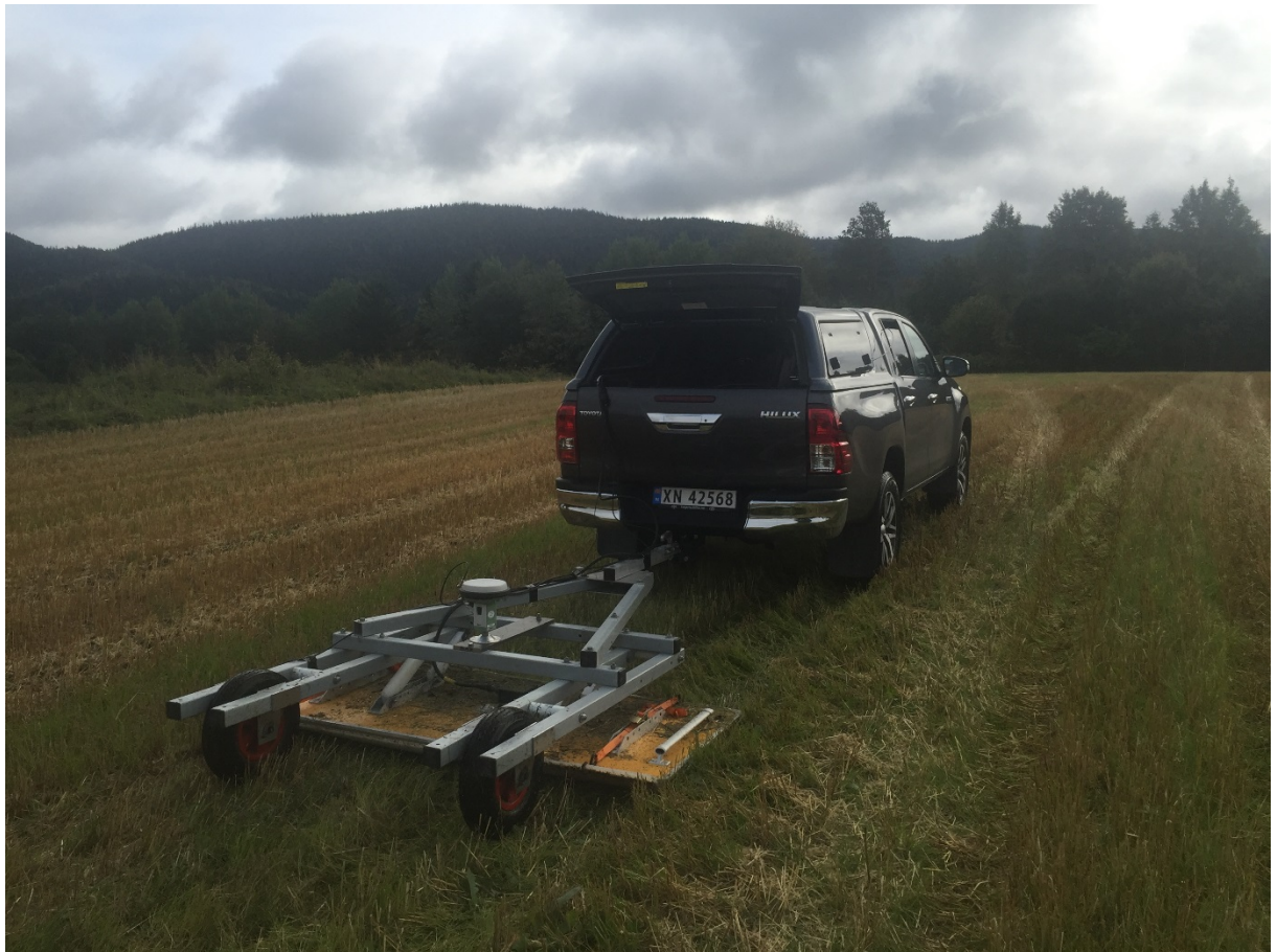
Figur 1: Datainnsamling i praksis. Georadarutstyret består av et antennesystem montert på et tilhengerfeste, som så blir trukket bak et kjøretøy med tilhengerfeste. Foto: Arne Anderson Stamnes, NTNU Vitenskapsmuseet
