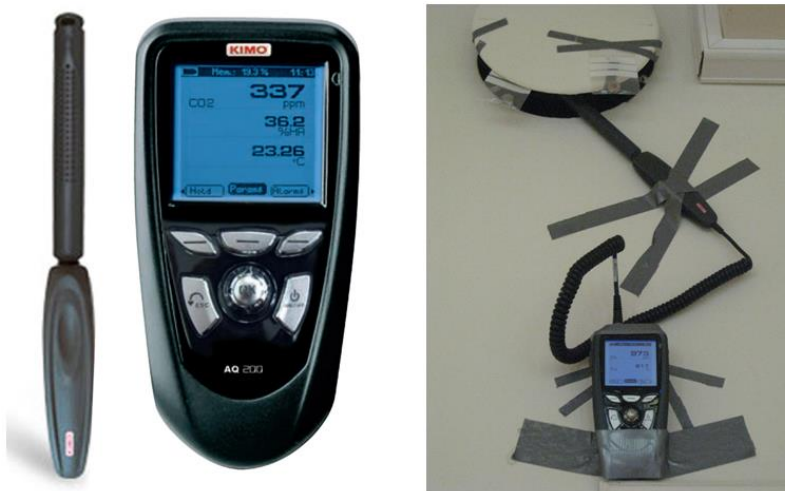
Figur 23: Fra venstre: KIMO AQ 200 og plassering av måleutstyr ved avtrekksventil
