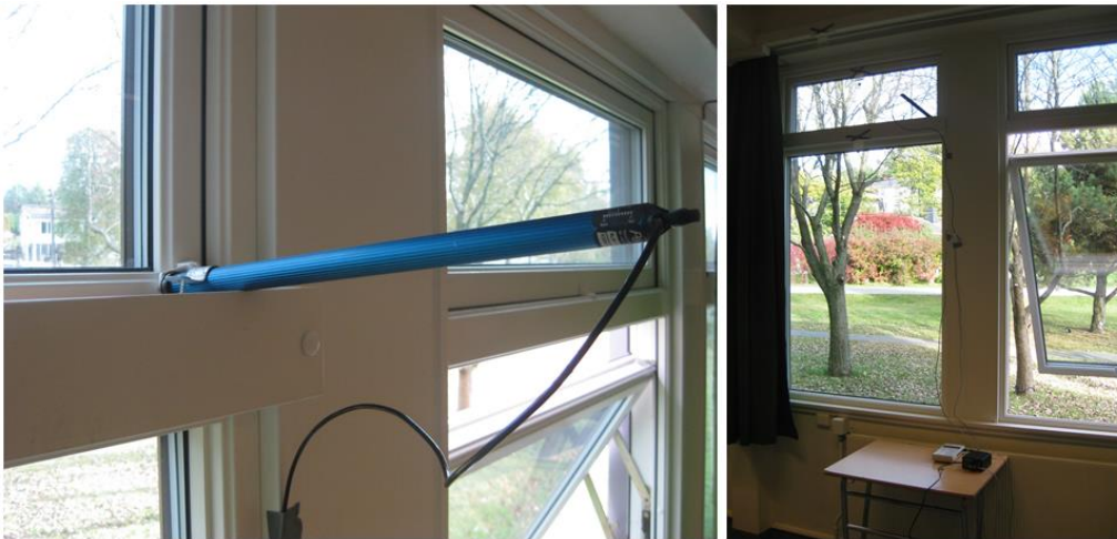
Figur 25: Måling av vindusåpning ved hjelp av Mitek måler
