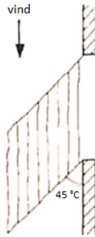
Figur 3: Flammeforlengelse ved vindpåvirkning sett ovenfra (Law, 1978).
