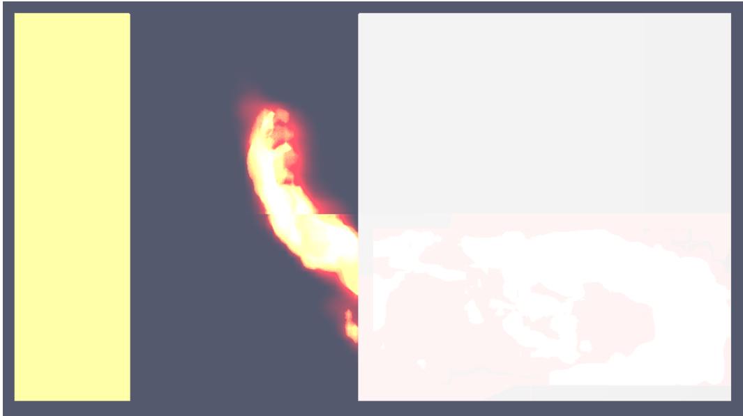
Figur C.6: Tverrsnitt av plumen i oppsett 3. Figuren viser en tydelig horisontal diskontinuitet ca. midt i plumen.
