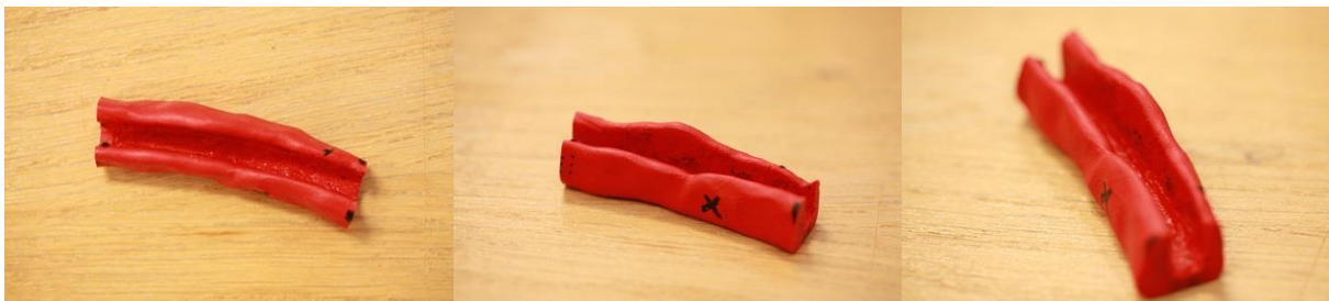
Figur 4.3. Form for 50 mm lang prøve. Prøveholder er laget av Fimo.
