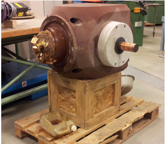
Figur 12: Testobjektet etter demontering. Isolatorene og oljepapiret er fjernet. Sekundærterminalene er klippet av og stikker ut av papiret.
