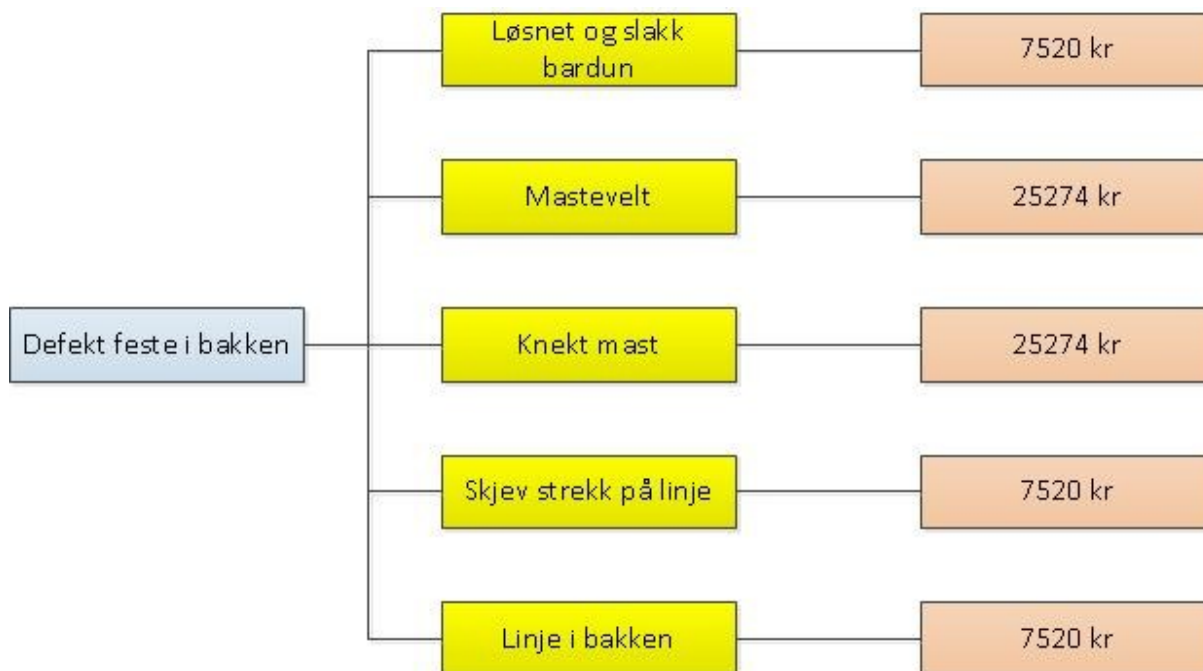
Figur 34 Eksempel på sviktmodell for bardun 2
