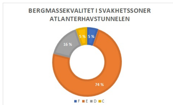
Figur 4.5: Oversiktsbilde over bergmassekvalitet i svakheitssonene i Atlanterhavstunnelen basert på data frå Todnem (2010).
