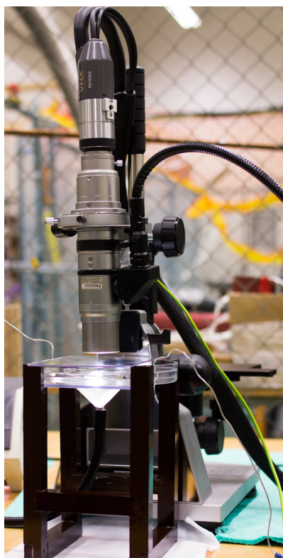
(a) Oppsett av testobjekt med Keyence mikroskop.
