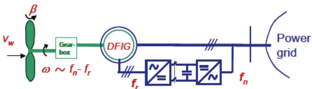
Figur 3.4 Prinsippskisse for en DFIG vindturbin [5]
