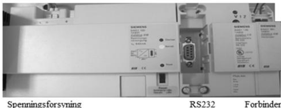
Figur 6-3 KNX produkter fra Siemens som er tilknyttet LOGO! Modulen
