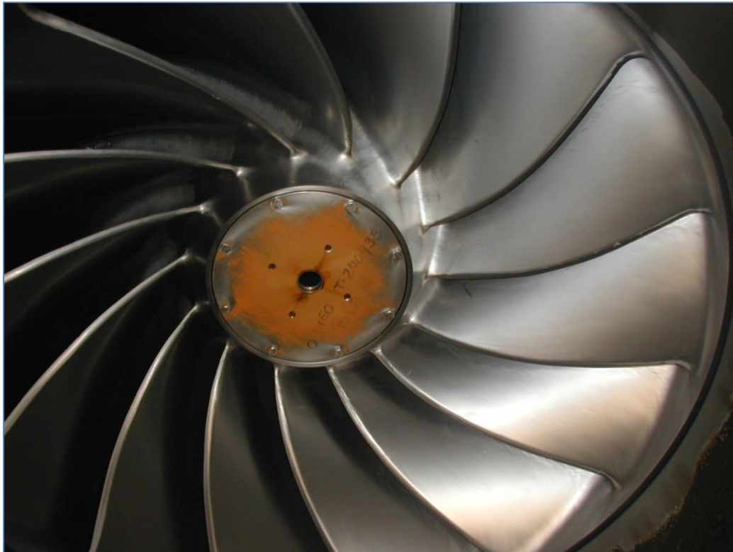
Figur 4.10: Løpehjul for turbin i Kvittingen kraftverk [10]
