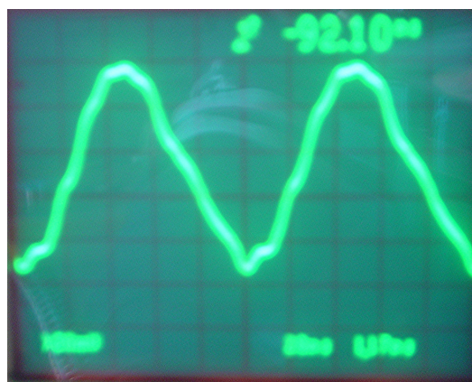
Figur C28 Målt gate-source spenning ved 20dBm inngangseffekt, hovedforsterker
