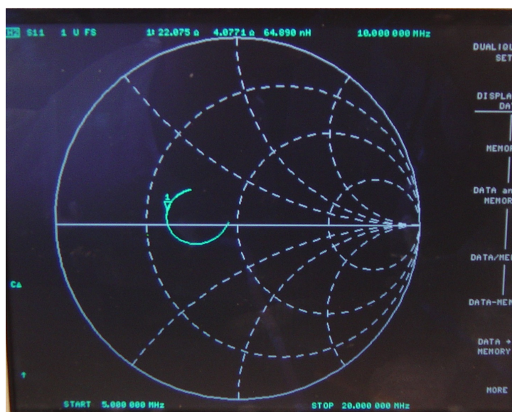
Figur C2 Målt S11 sett fra transistoren for hovedforsterker uten \pi -nettverk.
