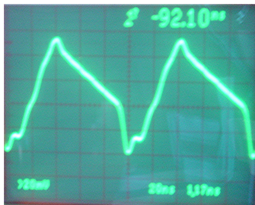
Figur C30 Målt gate-source spenning ved 20dBm inngangseffekt, peakforsterker
