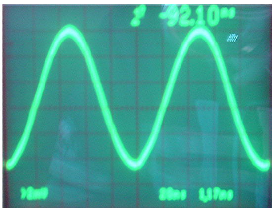
Figur C29 Målt gate-source spenning ved 0dBm inngangseffekt, peakforsterker
