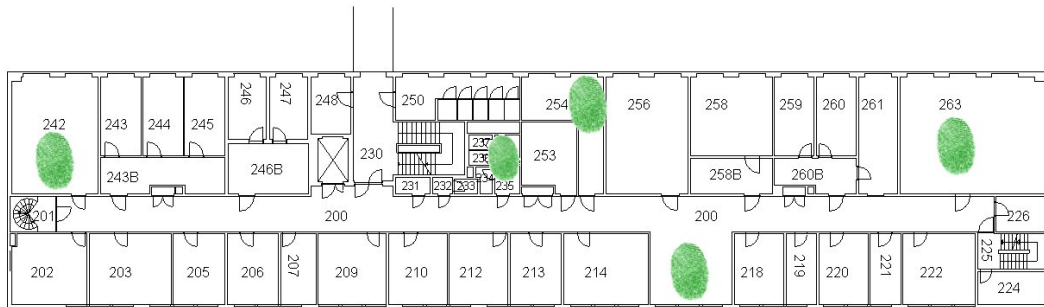
Figur 50: Her ser vi et eksempel på plassering av fingerprint for posisjonering i IT-bygget, 2.etasje.
