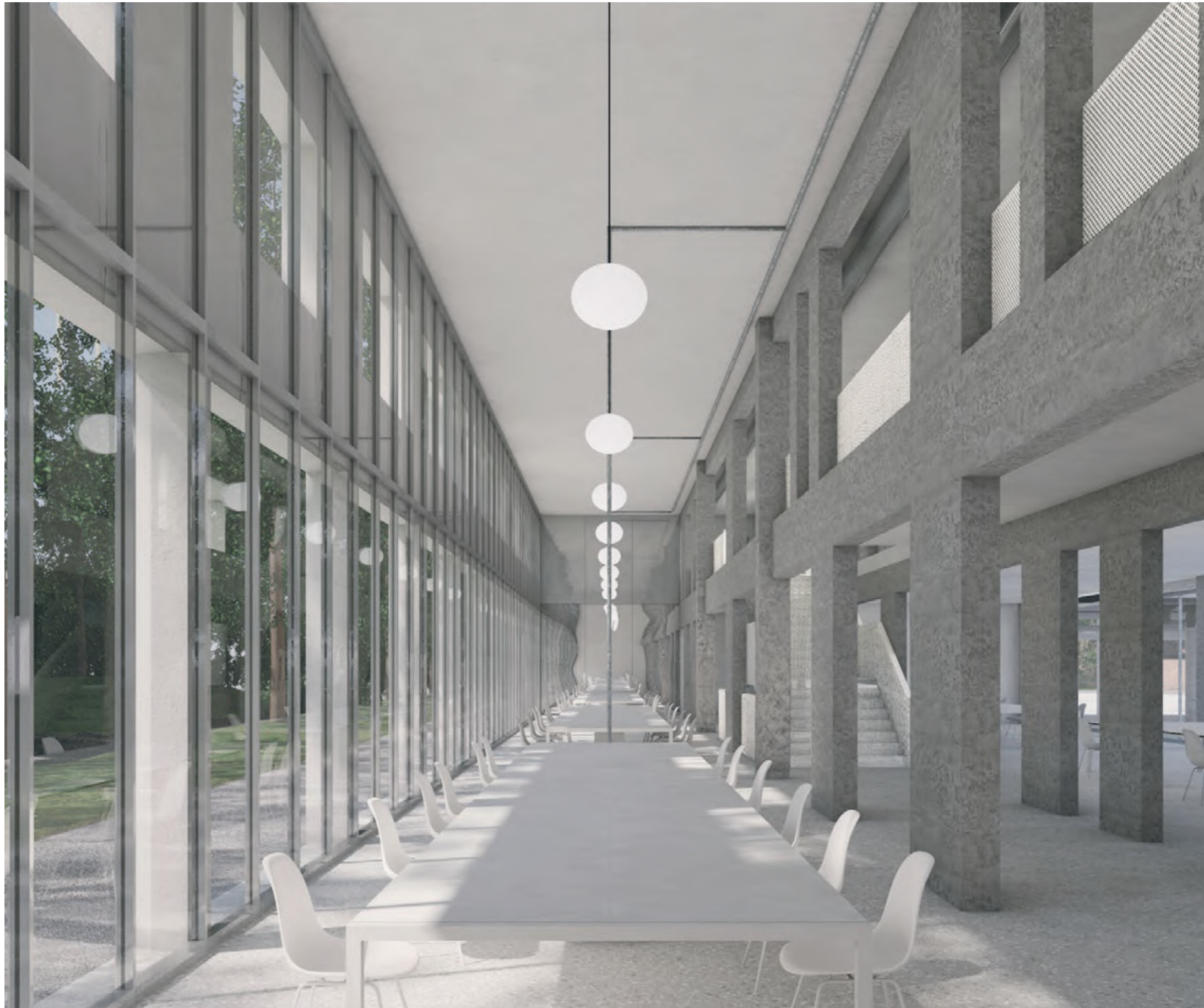
Tidligere var fasaden mot Storgata lukket, og rommene bakenfor små. Vi har valgt å fjerne deler av dekket, og åpne fasaden mot Storgata. I denne delen av bygget er alt overflødig strippet vekk, og bærestrukturen et sentralt element.
