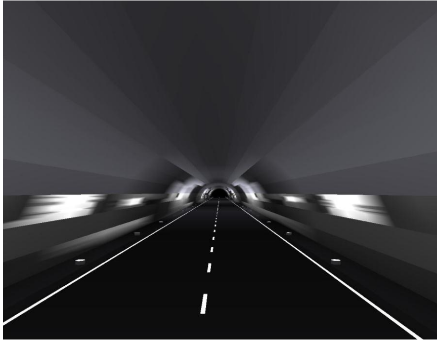
Figur 7.7: 20 meter avstand mellom armaturer montert vannrett.
