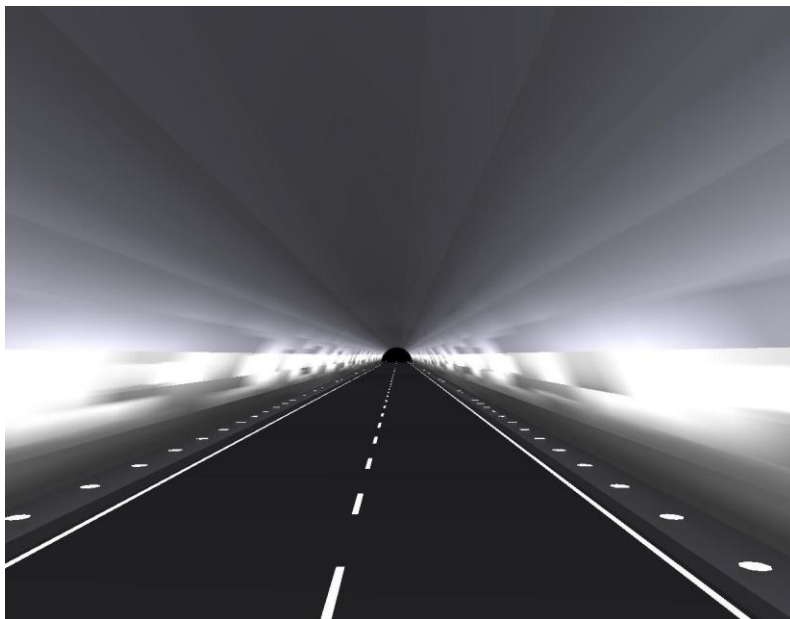
Figur 6.10: 5 meter avstand mellom armaturer montert vannrett
