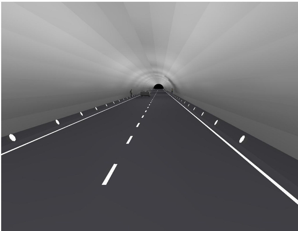
Figur 7.21: Armaturer montert 60 grader i forhold til veikanten, komplett tunnel dekket med hvite plater.
