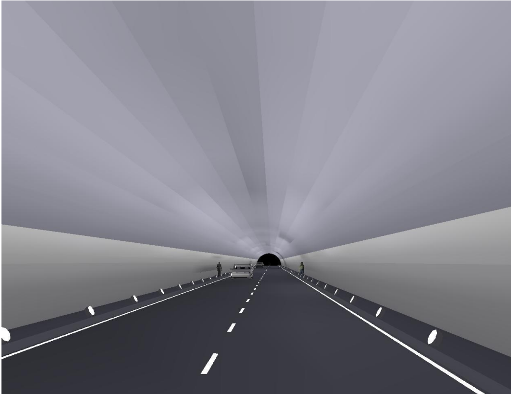
Figur 7.20: Armaturer montert 60 grader i forhold til veikanten, hvite vegger på 3 meter.
