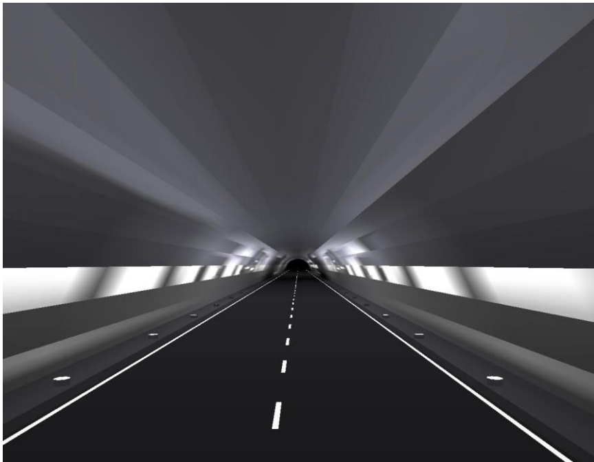
Figur 7.8: 15 meter avstand mellom armaturer montert vannrett.
