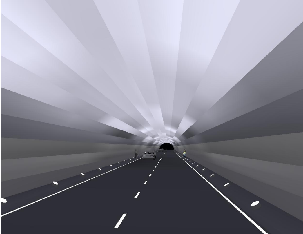
Figur 7.18: Armaturer montert 30 grader i forhold til veikanten, hvite vegger på 3 meter.
