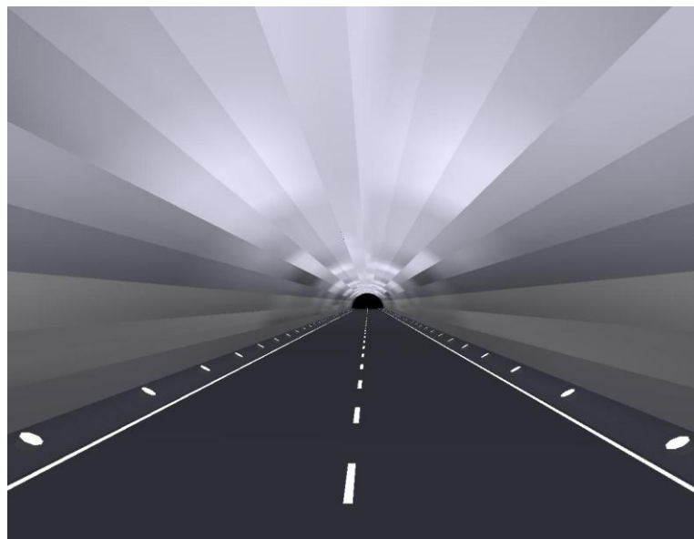
Figur 7.12: 10 meter avstand mellom armaturer montert 30 grader i forhold til veikanten.
