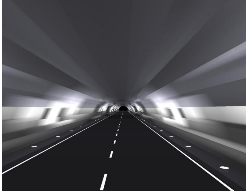
Figur 7.9: 10 meter avstand mellom armaturer montert vannrett.
