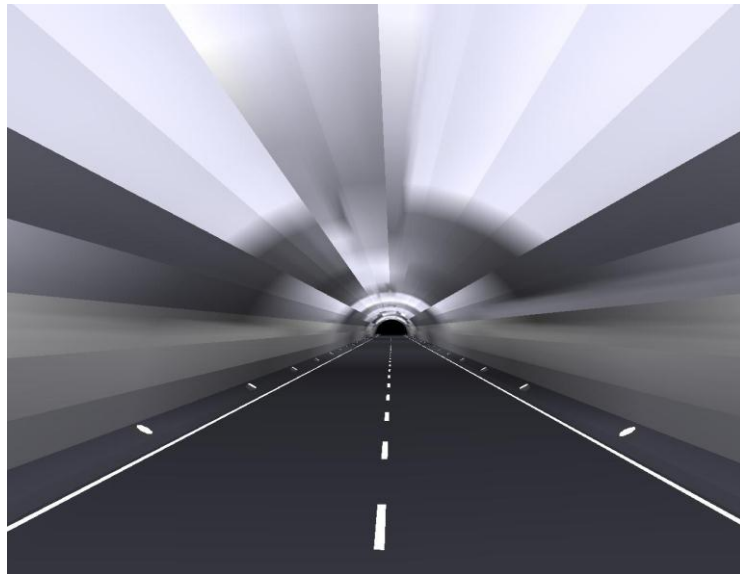
Figur 7.11: 20 meter avstand mellom armaturer montert 30 grader i forhold til veikanten.
