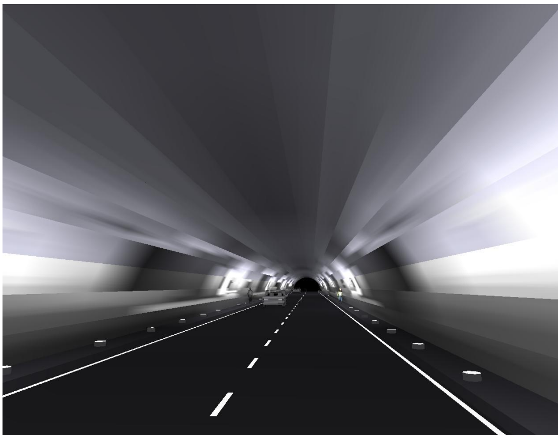
Figur 7.16: Armaturer montert vannrett i veikanten, hvite vegger på 3 meter.
