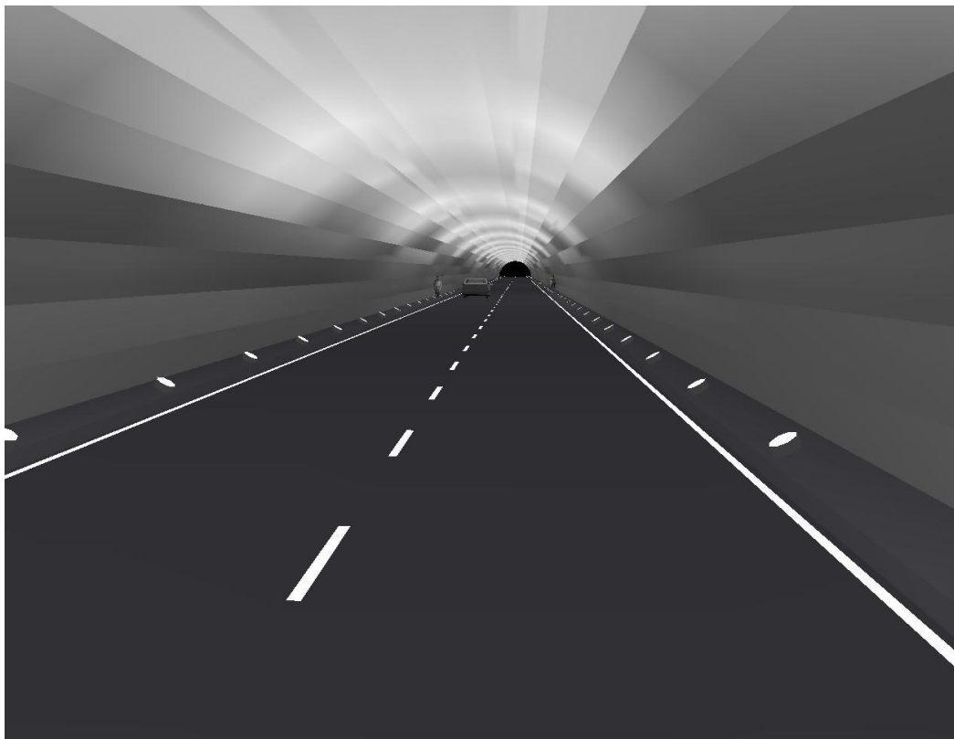
Figur 7.19: Armaturer montert 30 grader i forhold til veikanten, komplett tunnel dekket med hvite plater.
