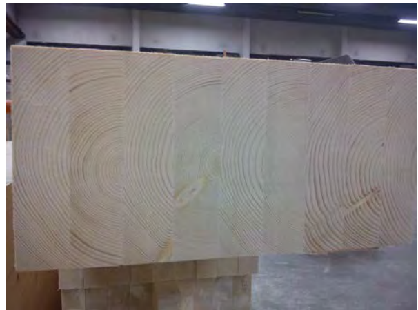
Kantstilte elementer(bordstabelement) tåler lengre spenn og egner seg derfor godt som etasjeskille
