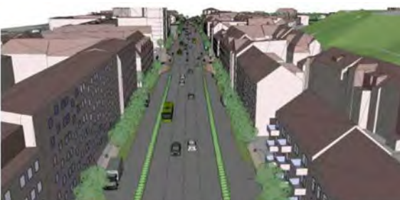
Figur 17: Nord for Abels gate sett mot nord – Seks kjørefelt inkludert sidestilt bussfelt og lokalgater med voreleveringslommer
