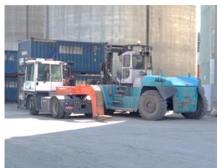
Figur 10 Terminalutstyr, Reach Stacker til venstre, Til høyre vises, traktor (til venstre i bilde) og motvekts truck (til høyre i bilde)
