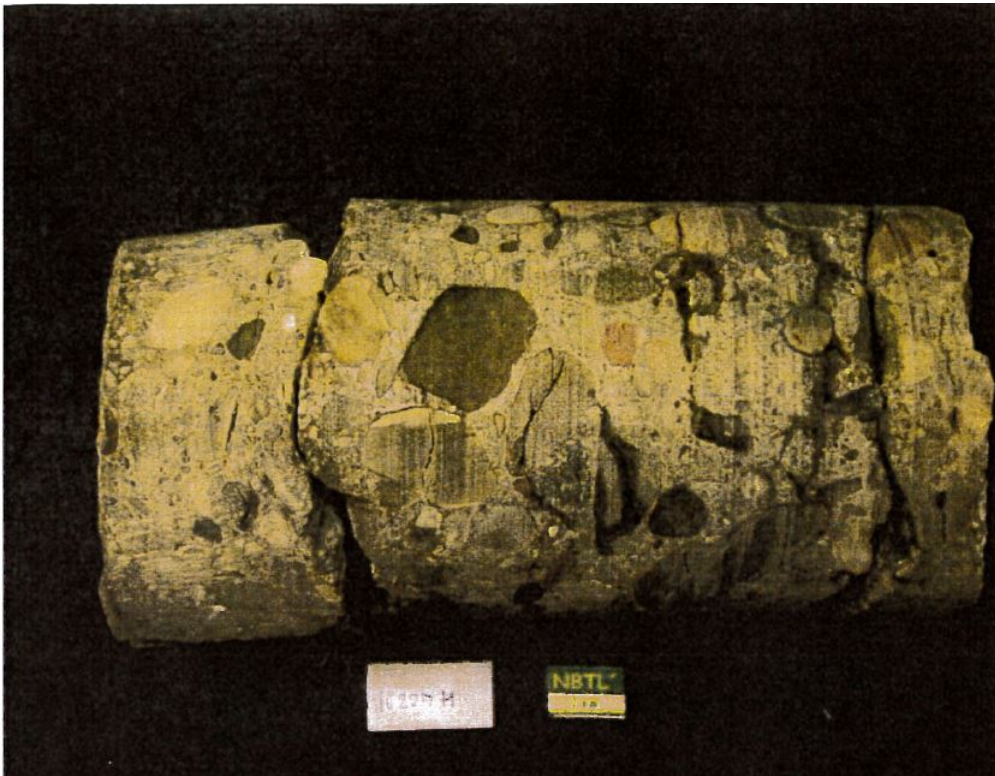
Figur 5.11: Fotografi borekjerne aks 19S, massiv
