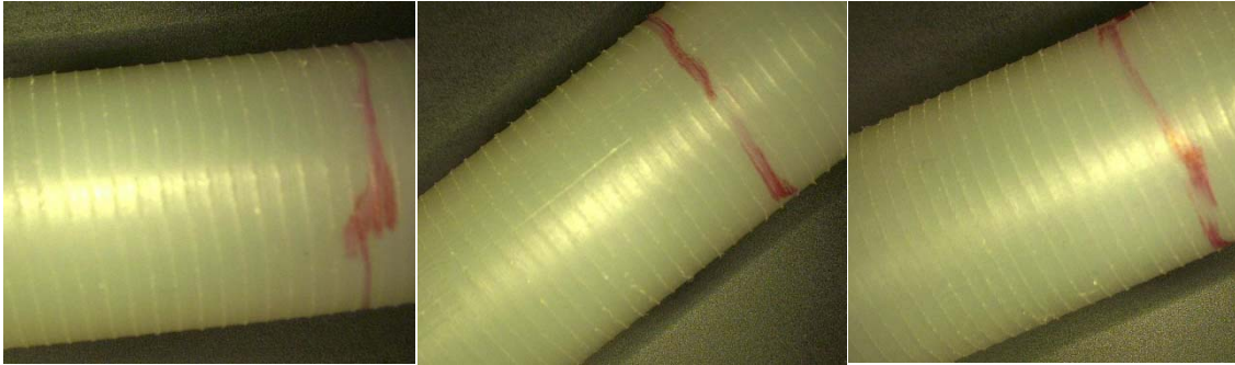
Figur 43 kabel 1, 3 og 4 (fra venstre). Den røde linjen indikerer vannfilmens posisjon uten påtrykt spenning.
