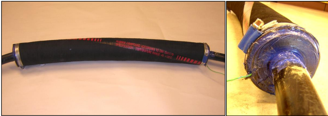
Figur 9: Kabelskjøten er plassert i slangen som er fylt nesten full av vann. Gummipropper er tredd inn på kablen og silikon (blå) er benyttet som ekstra tettemiddel. En slangeklemme er brukt for å holde gummiproppen på plass. Den grønne ledningen er termoelementet som er plassert på utsiden av skjøte
