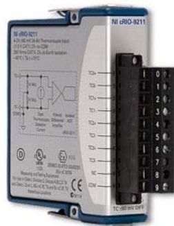
Figur 3.34: Bilde av NI 9211 IO-kort.
