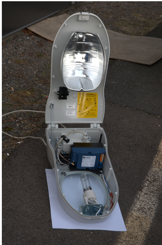
Figur 7.16: Bilde av armatur fra DEFA med lampenode fra Datek [41].
