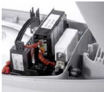
Figur 7.8: Til venstre en armatur med lampenode og til høyre en tavle med områdenode og tilhørende kommunikasjon fra Thorn
