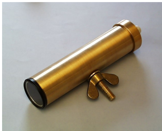
Figur 7.3: Bilde av luminansmeter utviklet av ved NTNU og SINTEF [26].
