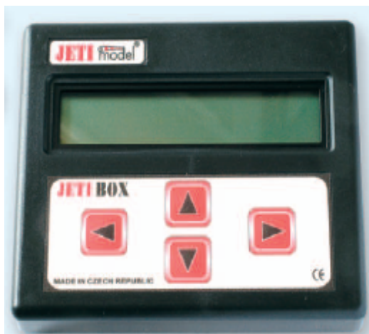
Illustrasjon 7.5.2: "Jetibox". Programmeringsenhet for Spin 77 Opto
