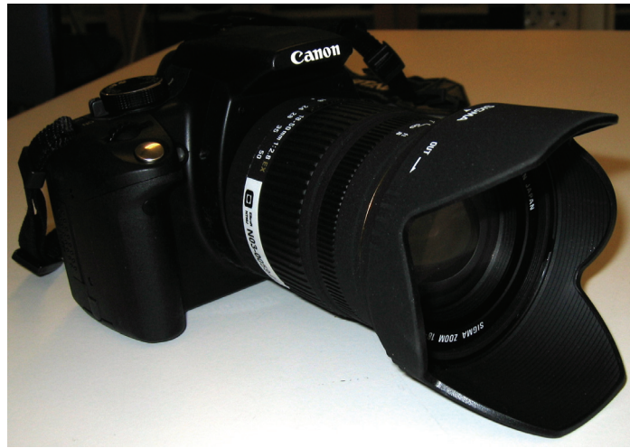
Figur 8-1: Kamera brukt til luminansmåling av veibaner
