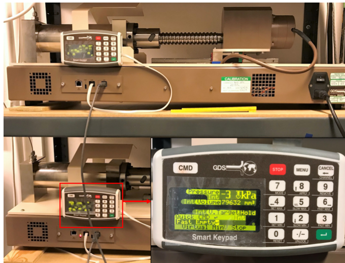
Figur 4.4: Celletrykkstempel (nederst) og baktrykkstempel (øverst) kan reguleres fra eget kontrollpanel eller GDSLAB på monitor.
