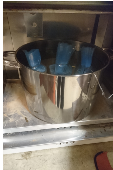
Figur 6.5: Lagring av prøver i kjele i varmeskap.
