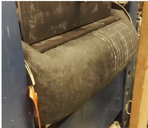
Figur 7.1: Tuben er lengre enn belastningsplaten
