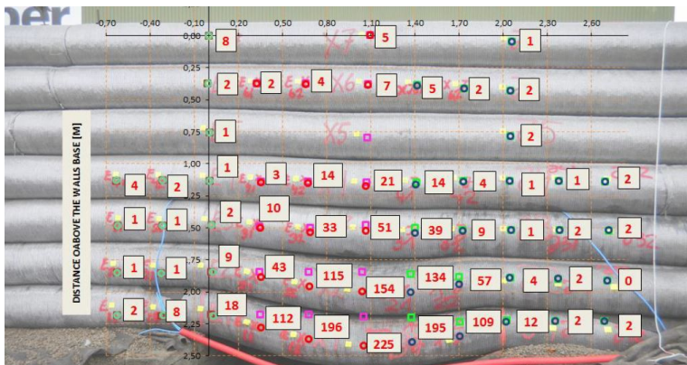
Figur 2.13: Konstruksjonens deformasjon ved undergraving, bildet i bakgrunnen er ikke et referansebilde (Górniak, 2013).
