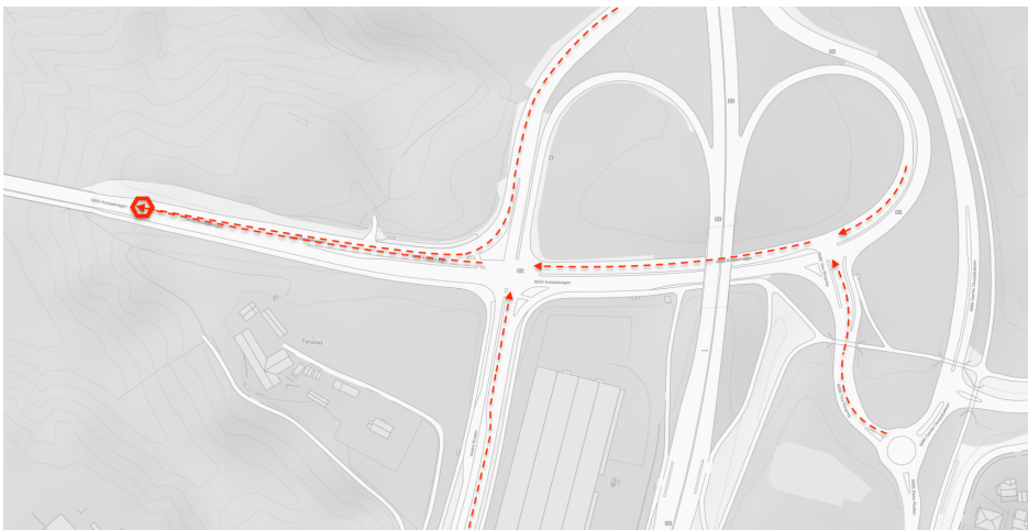
Figur 6.6: Tilbakeblokkering av Tonstadkryssets vestre og østre del på grunn av kapasitetsproblemer i flettepunktet før Bjørndalsbrua.
