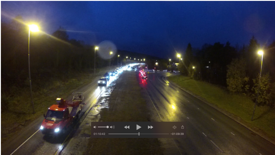
Figur 4.8: Rød bilmontert lift nedstrøms Flatåsenkrysset. For å finne hvordan reisetidene varierte, ble denne og flere andre karakteristiske kjøretøy gjenkjent på tvers av de ulike kameraene.
