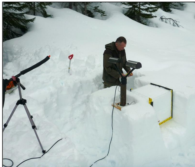
Figur 42. Fase 4) Forsøk med lenger varighet, forsøk 11: For å dytte boksen inn i snødekket må ein grave ut plass på begge sider.
