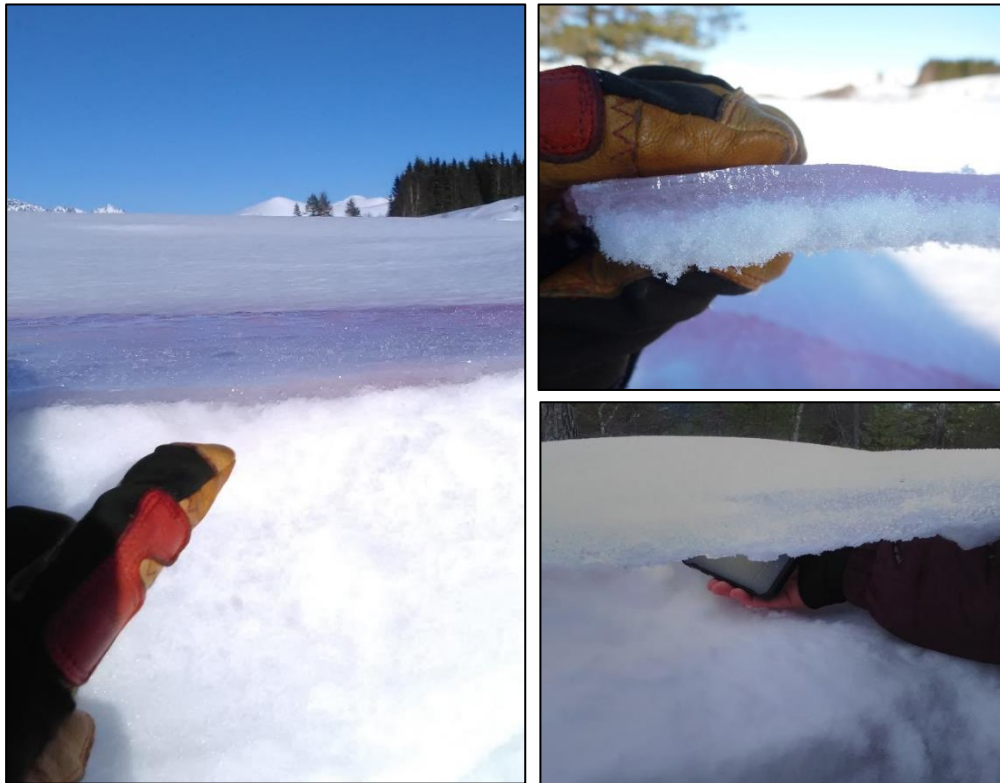
Figur 40. Fase 3) Komplette feltlab, forsøk 7 og 9: Vasstilførsel på kald snø (TL=-7,2°C og -5,5°C høvesvis, TSO=-8°C i begge forsøka).
