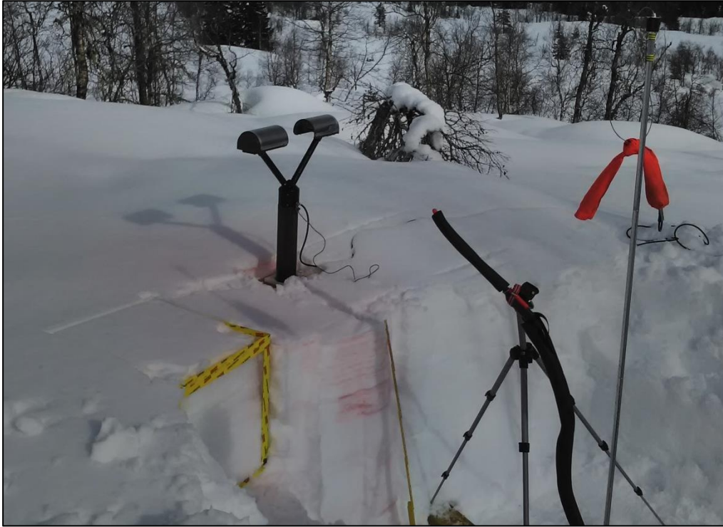
Figur 44. Dysene vart festa til eit kamerastativ. Biletet viser også disdromometeret og sørpeboksen.
