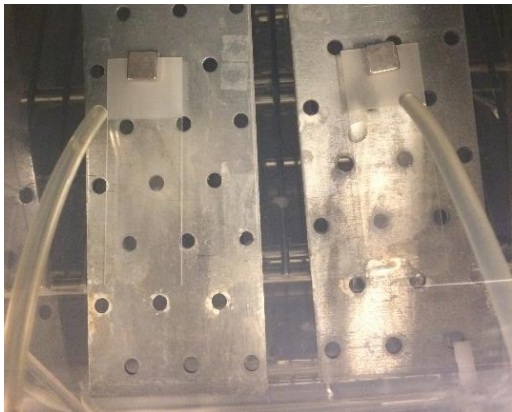
Figur 3.6 Prøveboks med slanger montert over glassplatene med bakterieprøver
