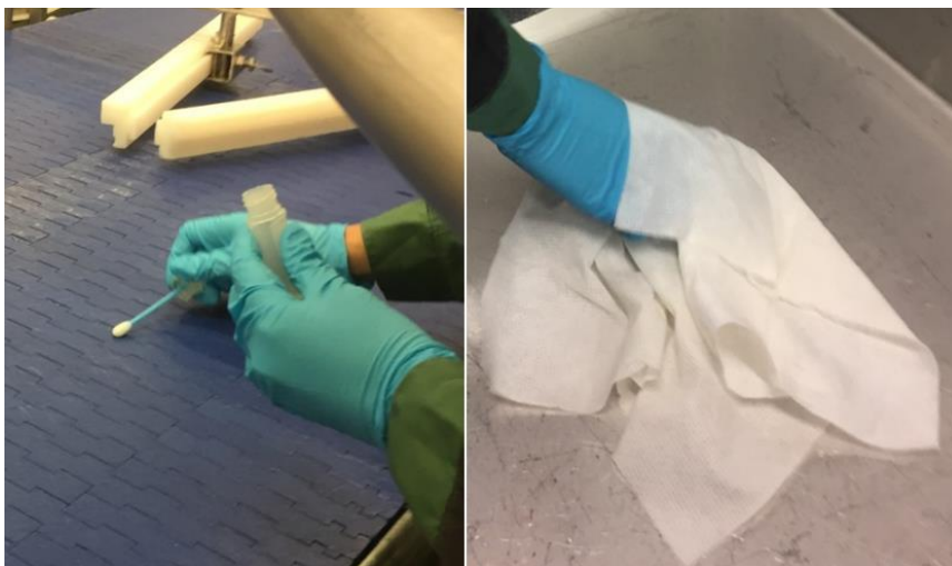
Figur 3.2 Prøvetaking på overflater i en fiskeforedlingsbedrift med svaber og prøvetakingsklut (Foto av Harry Westavik)
