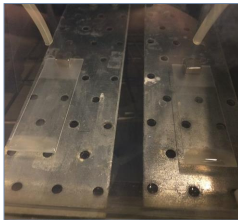
Figur 4.5 Prøveglass med biofilm ved dag 5
