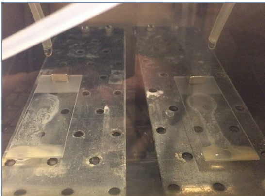
Figur 4.6 Prøveglass med biofilm ved dag 13
