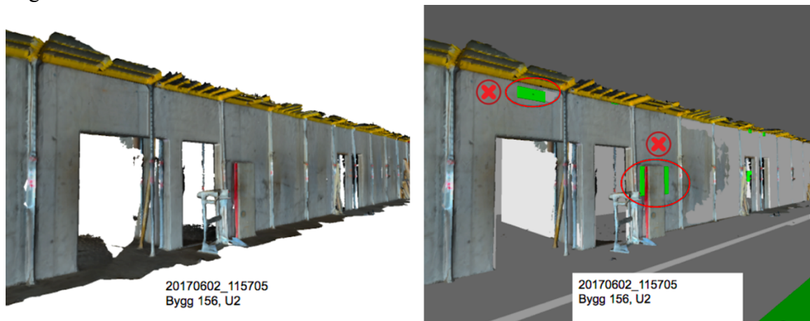
Figur 10: Mobilskanning og kontroll mot BIM-modell. (Seehusen 2017)
